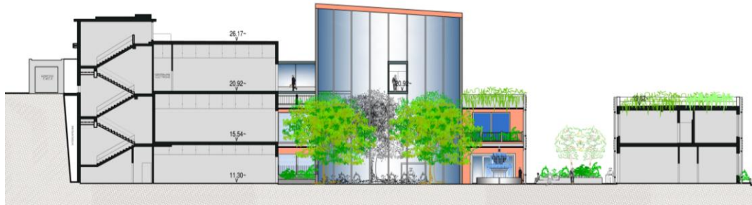
- SEZIONE TRASVERSALE CON IN CORPO SCALE/ASCENSORE -
