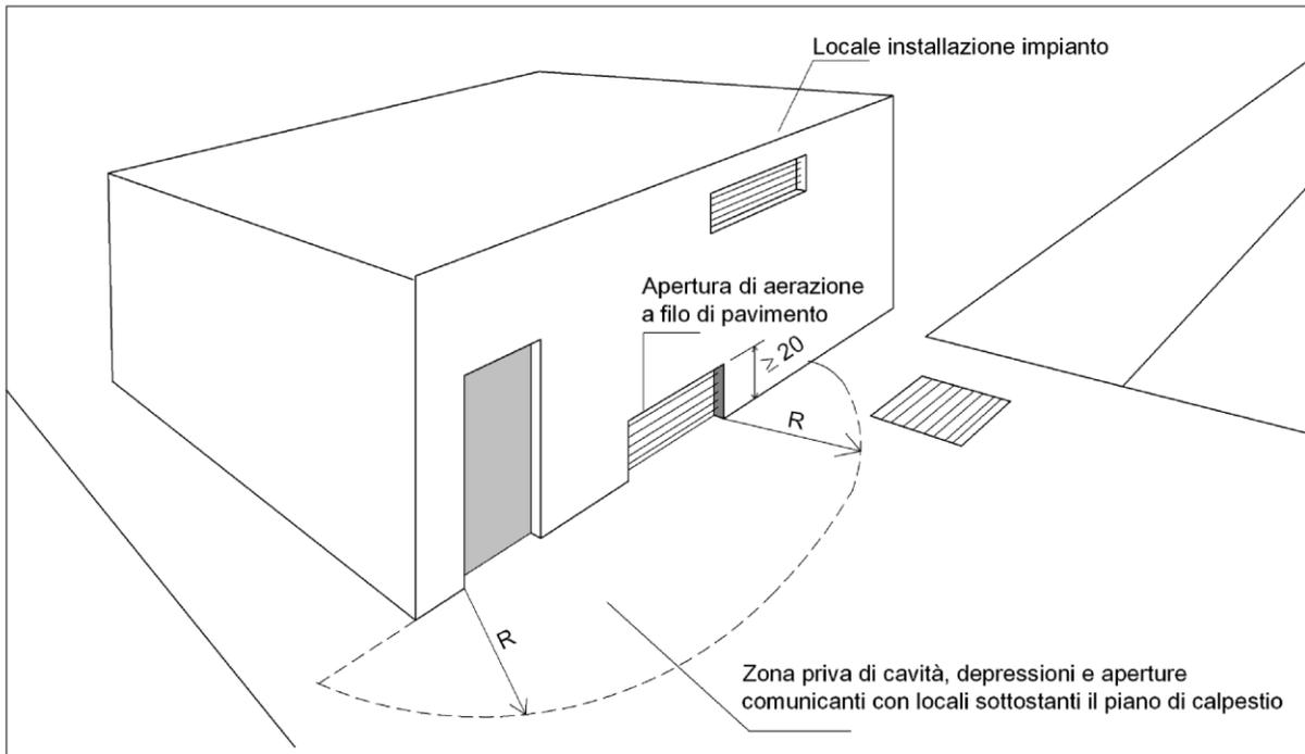
**Figura 81.5 - Ulteriori prescrizioni per le aperture di aerazione del locale centrale termica fuori terra, alimentato a gas di rete con densità superiore a 0,8, come prescritto dal D.M. 12 aprile 1996**
