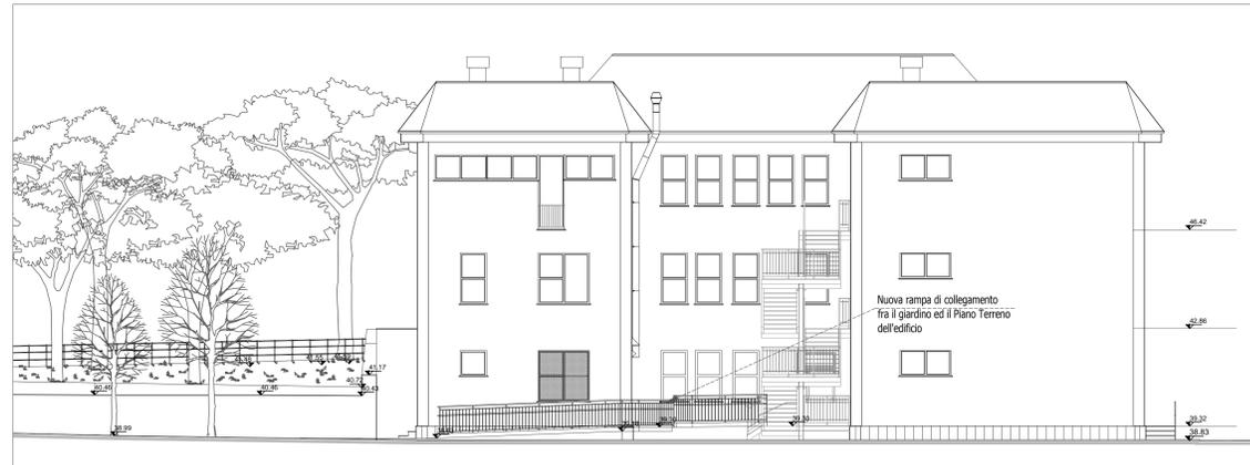
PROGETTO: Prospetto OVEST scala 1:100
