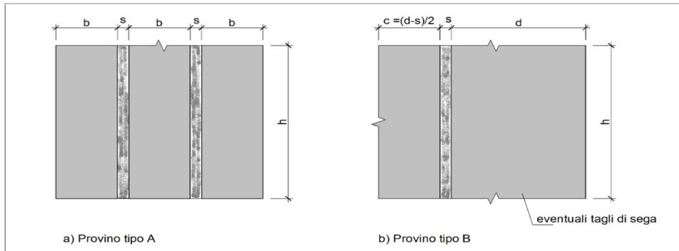
**Figura 19.5 - Dimensioni dei provini di muratura per prova, per la determinazione sperimentale della resistenza a taglio (UNI EN 1052-3)**
