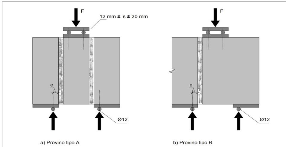
**Figura 19.6 - Carico di prova per la determinazione sperimentale della resistenza a taglio (UNI EN 1052-3)**
