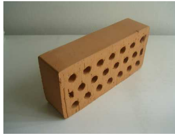
Figura 19.2 - Esempio di mattone semipieno 15\% < \phi \leq 45\% in laterizio per murature portanti 3
