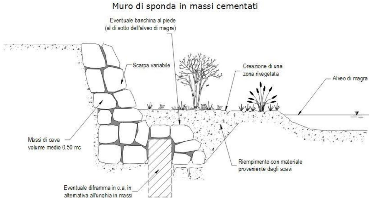
**Figura 23 - Schema tipo realizzazione intervento**
