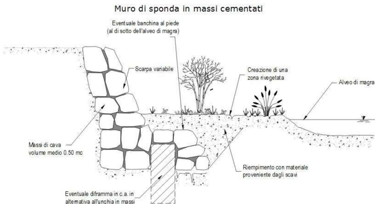
**Figura 14 - Schema tipo realizzazione intervento**
