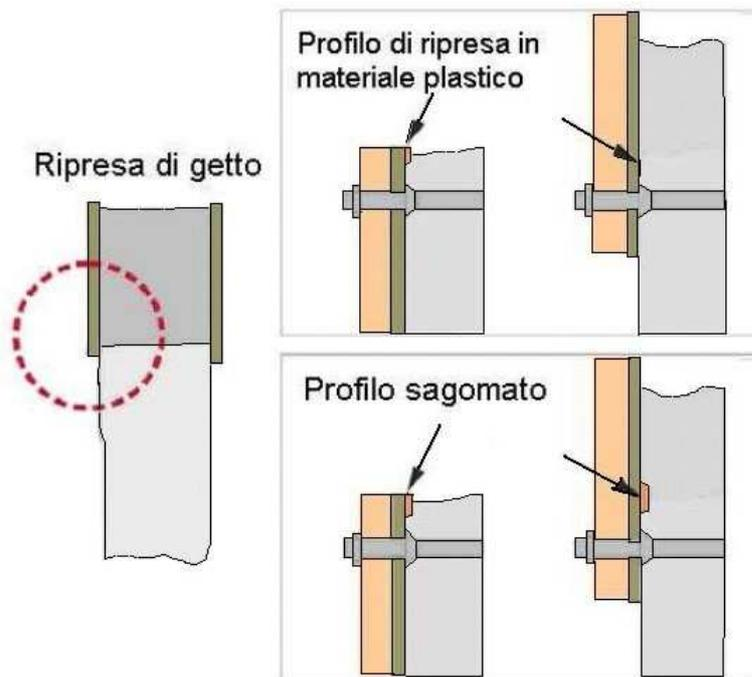
Figura 58.8 - Giunti delle casseforme in evidenza
