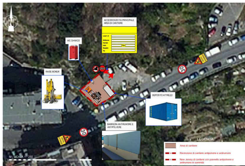
Figura 5.10 – Planimetria cantiere aeroforo via Berghini
