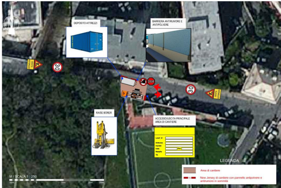
Figura 5.12 – Planimetria cantiere aeroforo Via Forte San Martino
