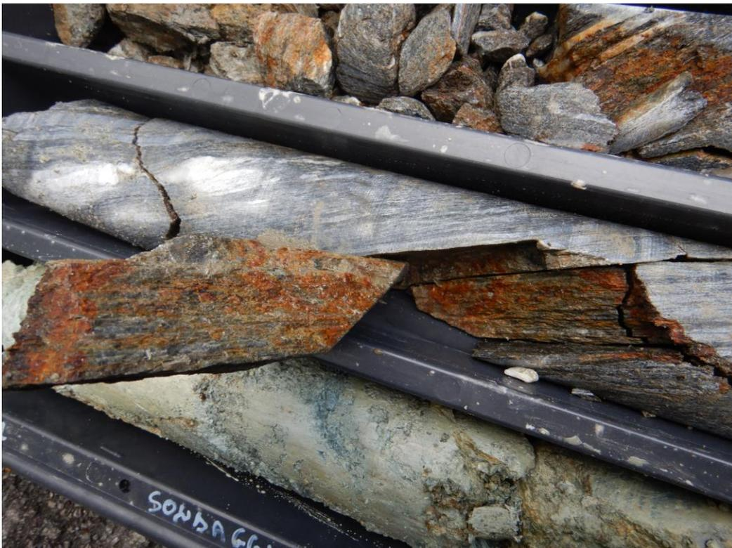
Foto 4 – Carota nella formazione dei calcescisti attorno a quota 13,5 nel S2 (cfr. campione S2-C3) caratterizzato da fratture beanti sia lisce sia più tipicamente scabre con diffuse patine di ossidazione
