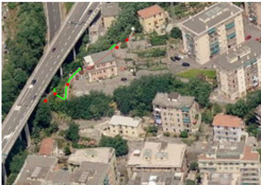
L'opera prevista consiste nella realizzazione, lungo la mattonata di Salita Brasile, di interventi di consolidamento costituiti da pali verticali, con lunghezze variabili, giuntati in testa da un cordolo in cemento armato.
