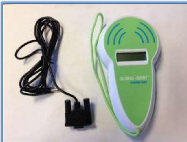
E' un dispositivo di lettura portatile per trasponder passivi (microchip) impiantati negli animali a norme ISO 11784 & 11785 con protocolli di trasmissione **FDX B, HDX, FDX A** (Destron, Avid, FECAVA, microchip in commercio prima del 1996). Costruito per non infastidire gli animali ed essere di facile utilizzo.
