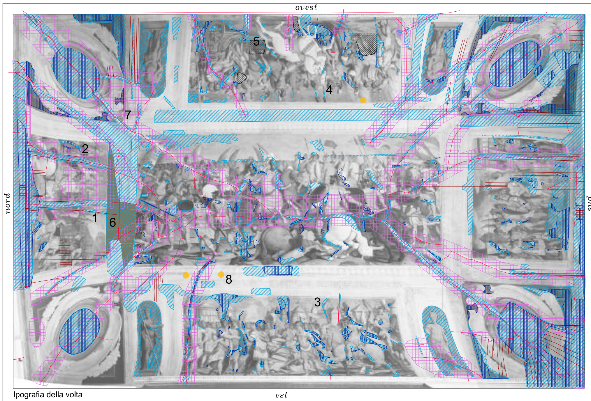
1 DSC_0718: Fessurazione, colature, efflorescenze saline e macchie dovute a infiltrazioni
