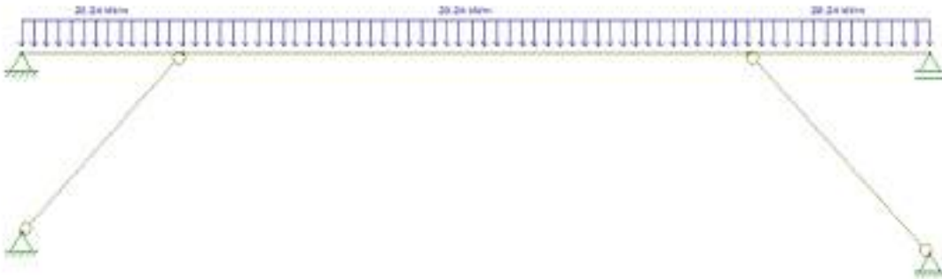
Figura 9. Schema statico adottato per le travi principali
