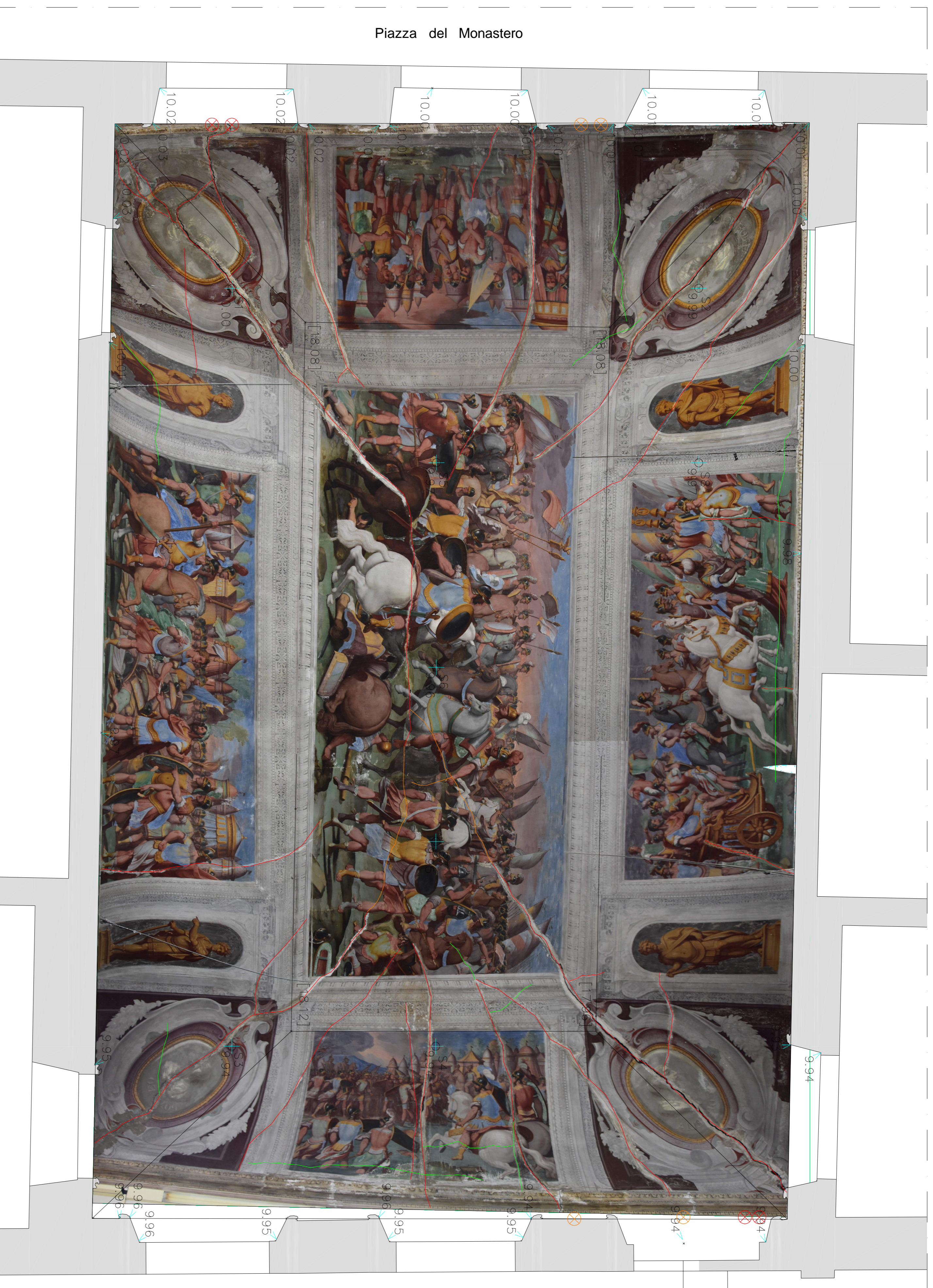
Planimetria Rilievo del quadro fessurativo della volta
