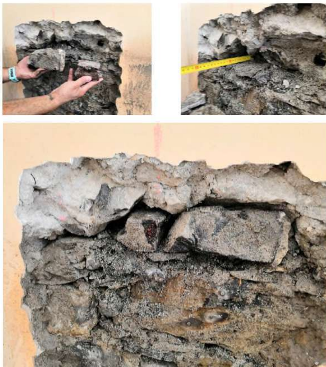
Figura 10. Distacco dei blocchi lapidei durante la prova 3.
