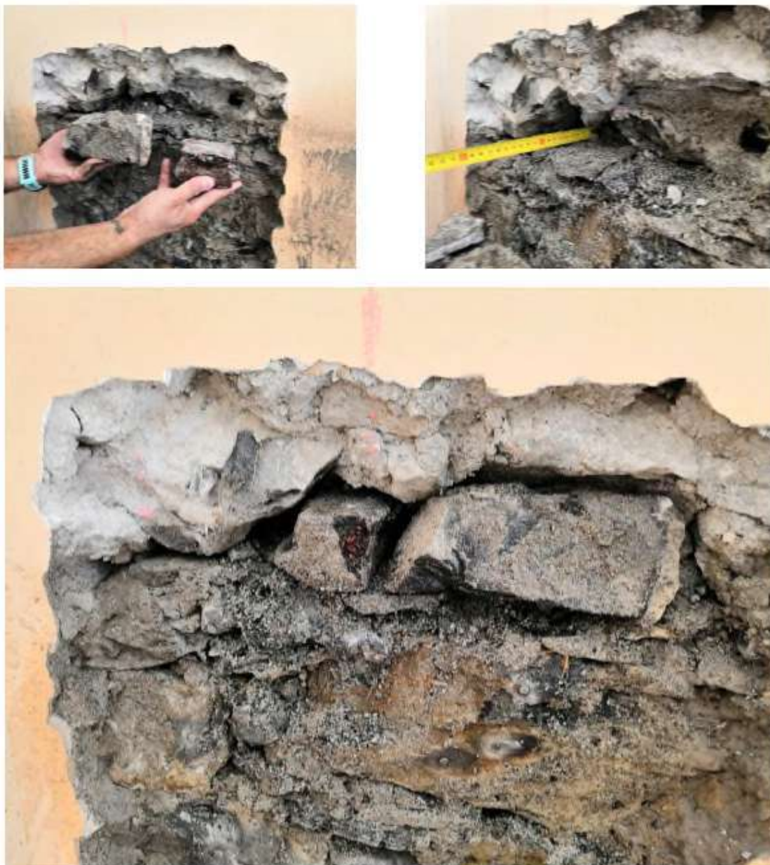
Figura 61. Distaccamento dei blocchi lapidei durante la prova 3.
