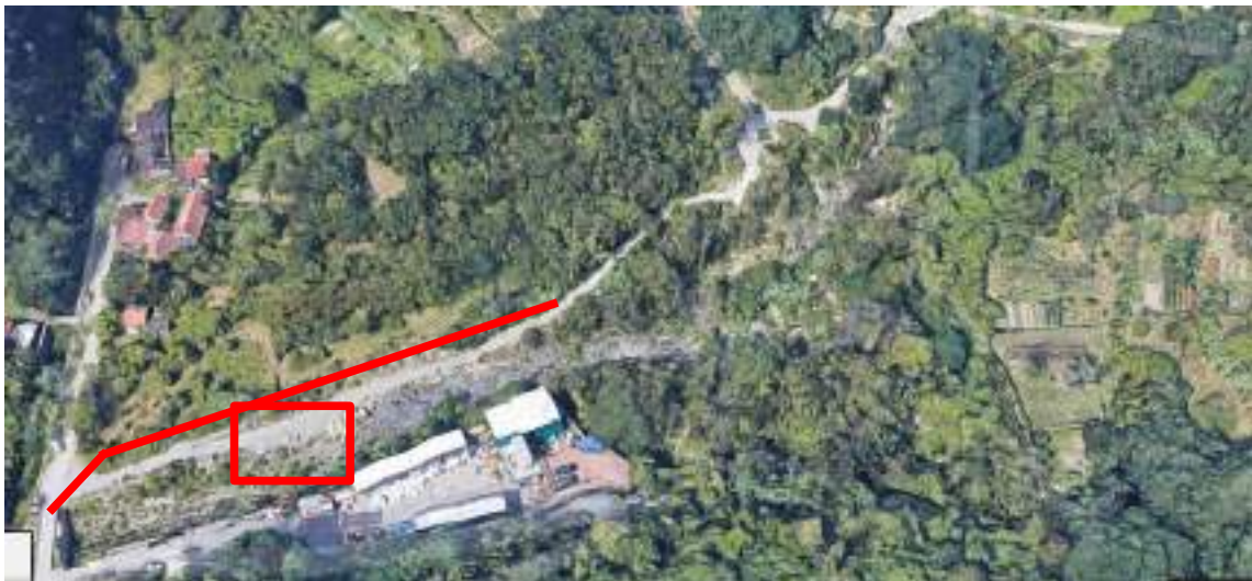
Planimetria con indicazione viabilità provvisoria e area logistica
