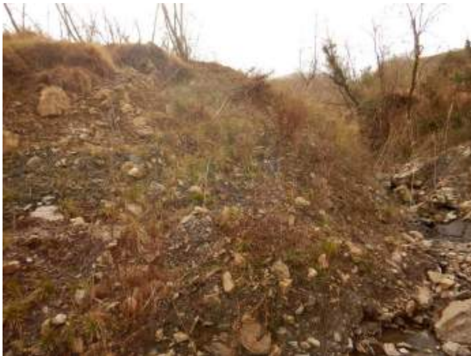
Foto 13 – Immagini di assieme (a) e di dettaglio (b) che mostrano la natura della potente coltre di copertura presente alla confluenza tra il Rio Bastia e il Rio Maggiore costituita da alluvioni miste a materiale di pendio, con abbondanza di clasti grossolani e blocchi di calcare marnoso.
