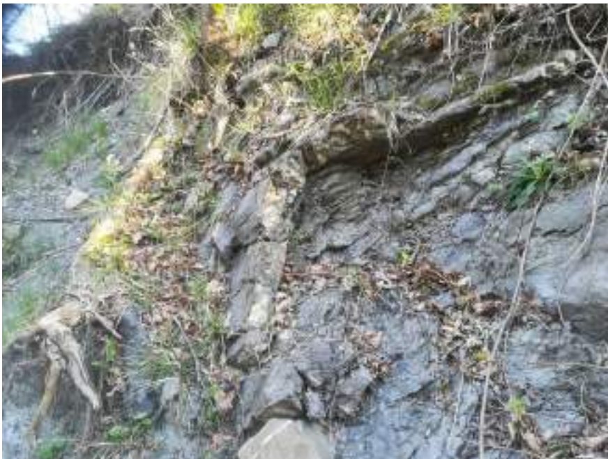
Foto 11 – Struttura plicativa presente sulla sponda destra del Rio Bastia con fianchi rispettivamente 100/70N e 170/30E e asse diretto circa N50 con debole inclinazione 25° verso NE. Con stesso allineamento si nota la fratturazione ortogonale alla S0 con discontinuità ben realizzate nei soletti più tenaci.
