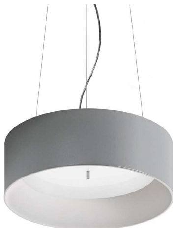
Immagine 1 – Corpo illuminante a sospensione tipo A1 ARTEMIDE M240261 TAGORA 570 o eq LED doppia emissione (dir.+ind.) col.bianco - Pot. 72W 4675lm 3000K RG0
