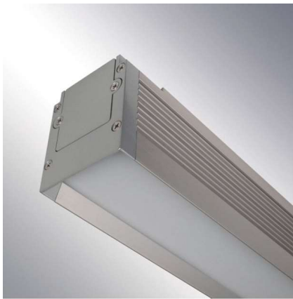
Immagine 7 – Corpo illuminante a plafone tipo N1 Norlight SL.EVO plafone PMMA satinato IP54 per esterno T90CA..1 o eq. - RG0 Pot.45W 3560lm 3000K 230V.
