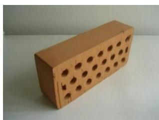
Figura 19.2 - Esempio di mattone semipieno 15\% < \Phi \leq 45\% in laterizio per murature portanti
