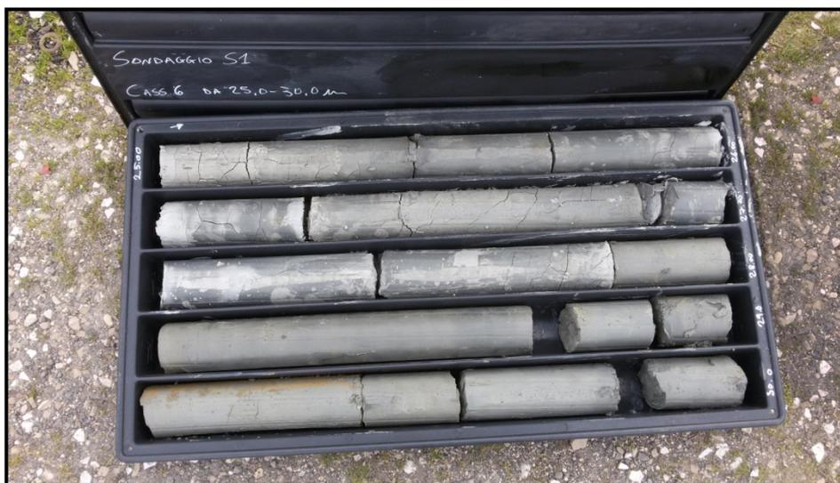
Foto n.9: S1 - Dettaglio Cassetta 6 da 25,0 a 30,0 m
