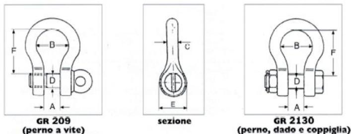
Il dimensionamento del grillo deve essere effettuato in combinazione di carico RARA poiché tutte le schede fornite dai produttori di grilli presentano un coefficiente di sicurezza intrinseco pari a 5.00. A fronte di ciò, volendo comprendere la sovrarresistenza attribuita al grillo, è necessario moltiplicare i due coefficienti di sicurezza utilizzati per il progetto della trave di ripartizione:
