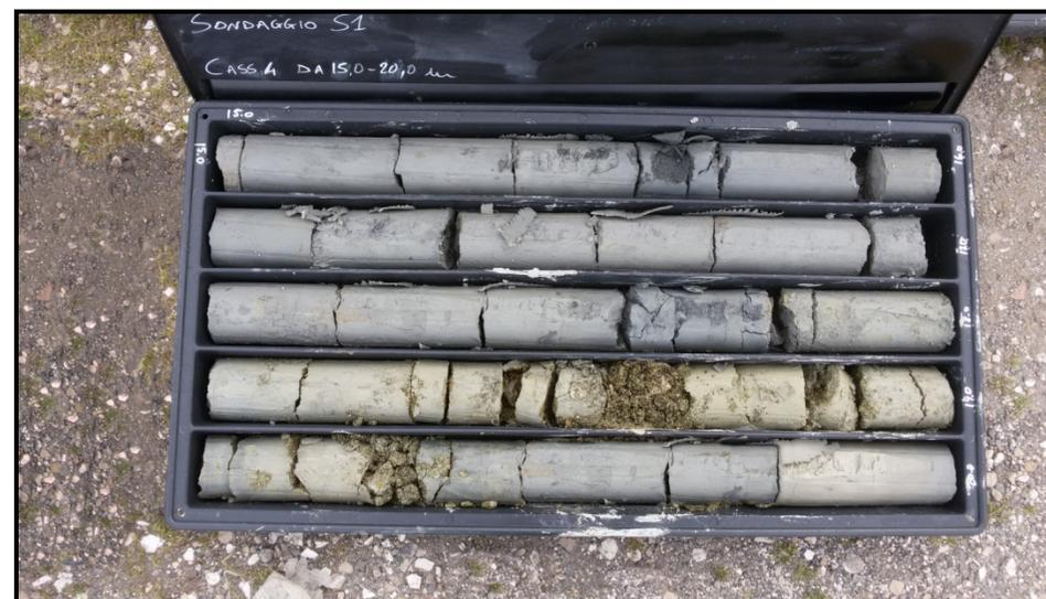
Foto n.7: S1 - Dettaglio Cassetta 4 da 15,0 a20,0 m
