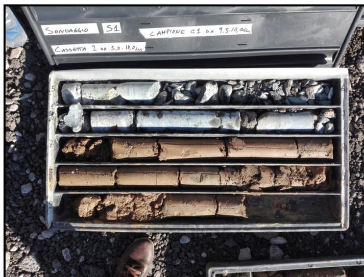
Foto n.5: S1 - Dettaglio Cassetta 2 da 5,0 a10,0 m
