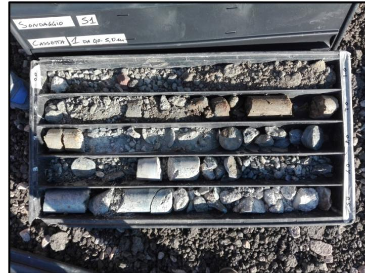
Foto n.3: S1 - Dettaglio Cassetta 1 da 0,0 a5,0 m
