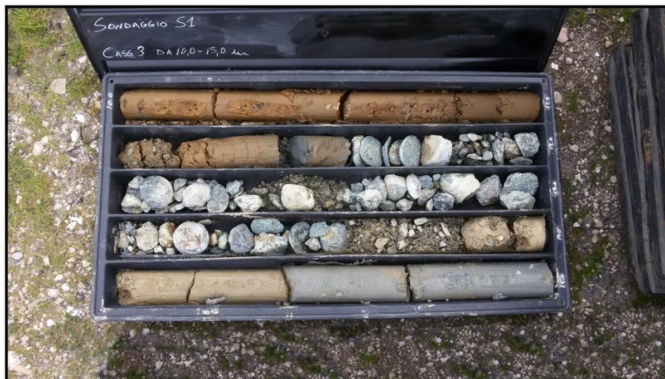
Foto n.6: S1 - Dettaglio Cassetta 3 da 10,0 a15,0 m
