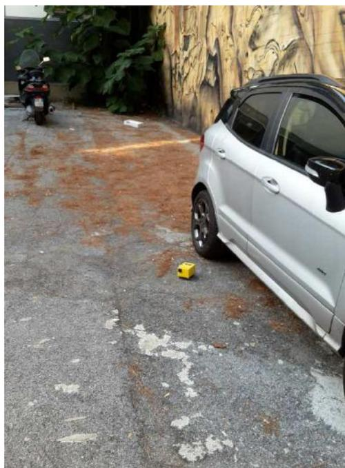
Figura 22 Indagine sismica passiva a stazione singola H/V
