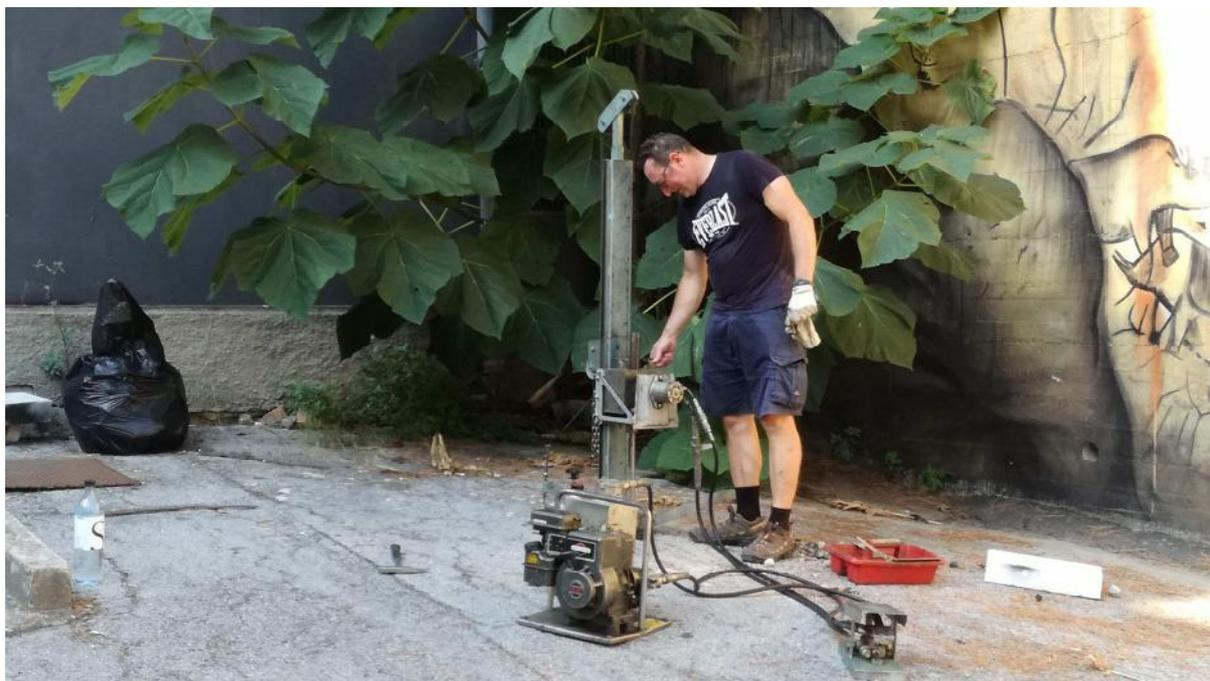
**Figura 18 Prova penetrometrica dinamica**
