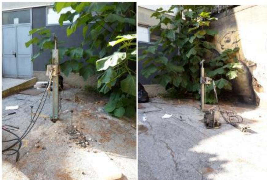
**Figura 2.** Esecuzione prova penetrometrica esterna
