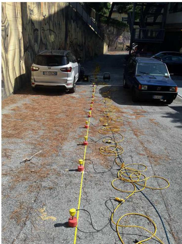
Figura 21 Sismica a rifrazione (foto scattata da geofono 1)
