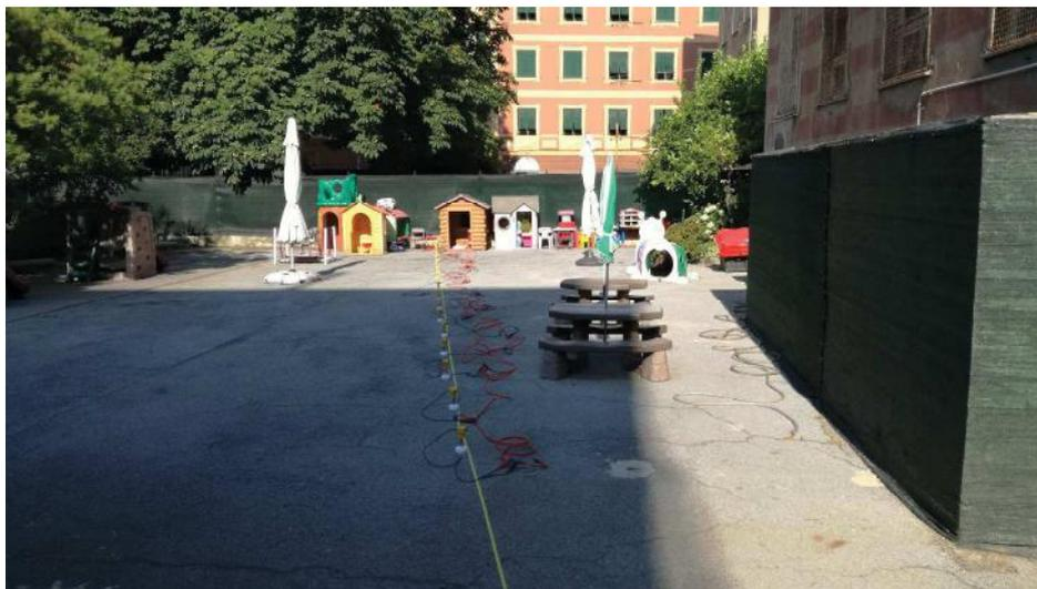
Figura 31 Vista dello stendimento sismico dal cortile della Materna L.Stallo (direzione circa E-W)
