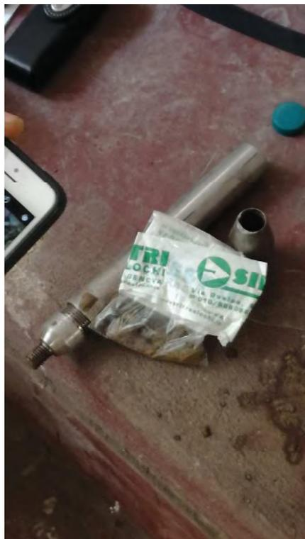
**Figura 26** Campionatore e campione di terreno prelevato a quota 1.20 da piano di calpestio vano caldaia (circa 3.00 da p.c esterno)
