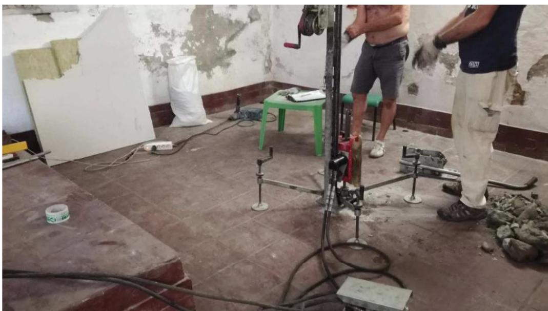
**Figura 25** Penetrometro dinamico in posizione su prova n. 2
