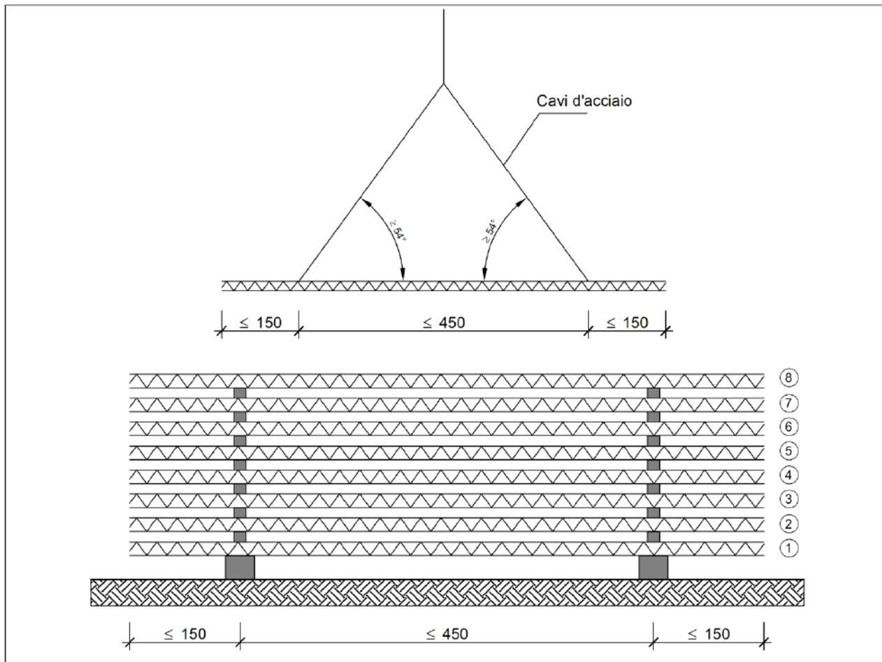
**Figura 22.6 - Esempio di stoccaggio di travetti tralicciati**
