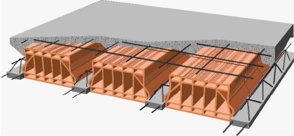
**Figura 22.2 - Esempio di solaio in cemento armato a travetti tralicciati e blocchi interposti<sup>3</sup>**
