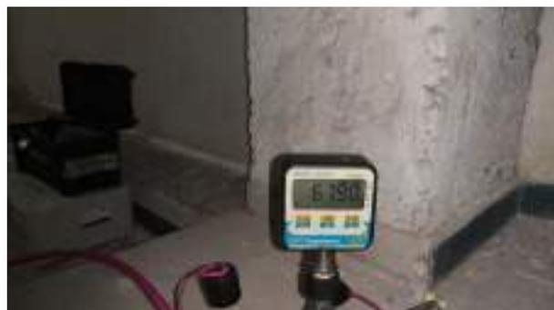
Figura 19. Risultato della prova di trazione TRZ\_02 (pressione [bar] )
