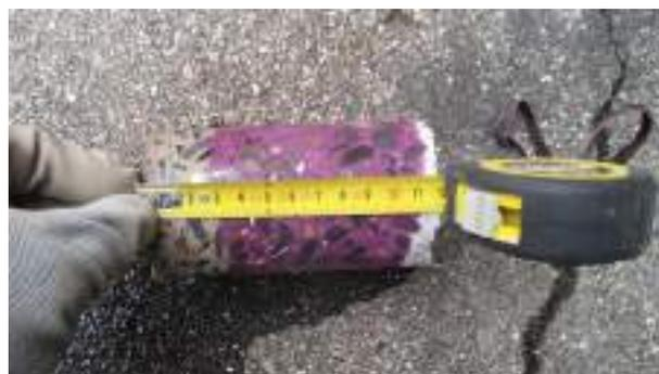
Figura 13. Carota e verifica della carbonatazione
