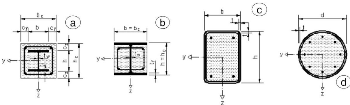
**Figura 66.1 - Tipi di sezioni per colonne composte**
