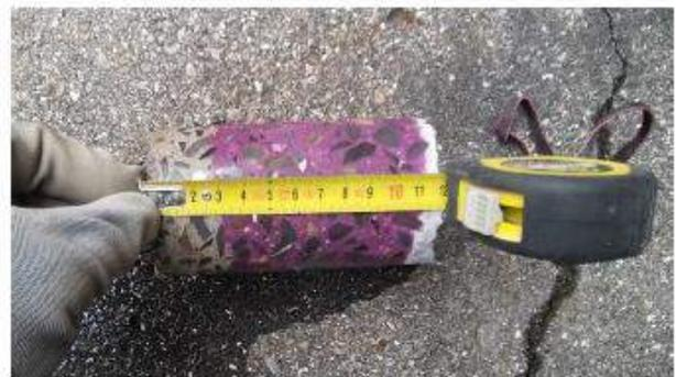
Figura 13. Carota e verifica della carbonatazione
