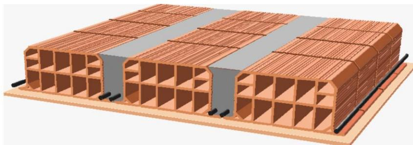
Figura 22.1 - Esempio di solaio in cemento armato gettato in opera<sup>2</sup>
