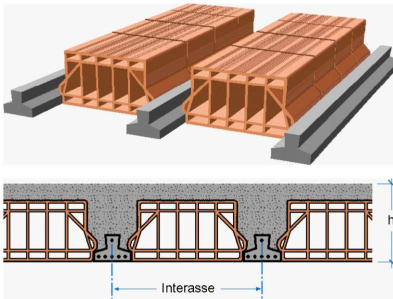
**Figura 22.3 - Esempio di solaio in cemento armato a travetti in cemento armato e blocchi interposti<sup>4</sup>**
