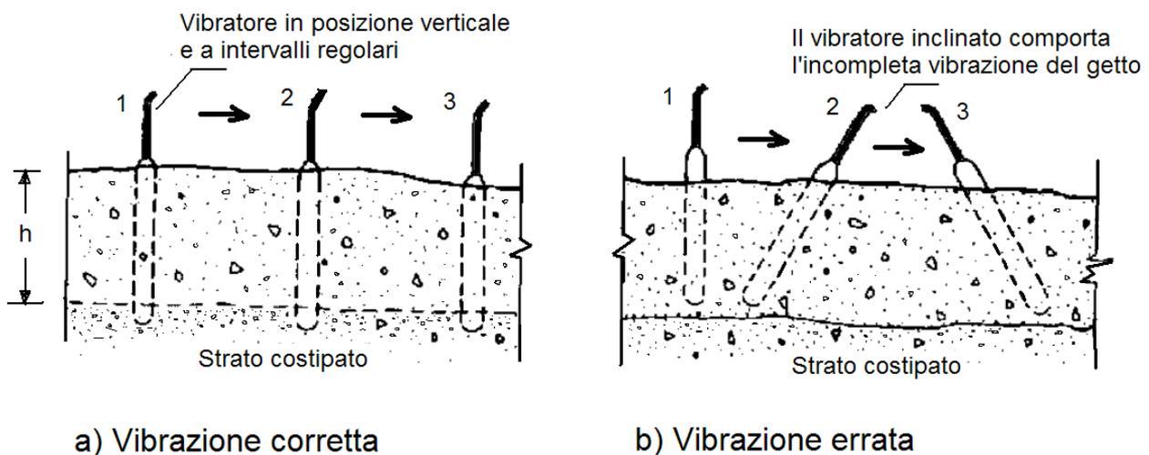
**Figura 58.5 - Esecuzione del getto e modalità di costipazione mediante vibrazione interna**
