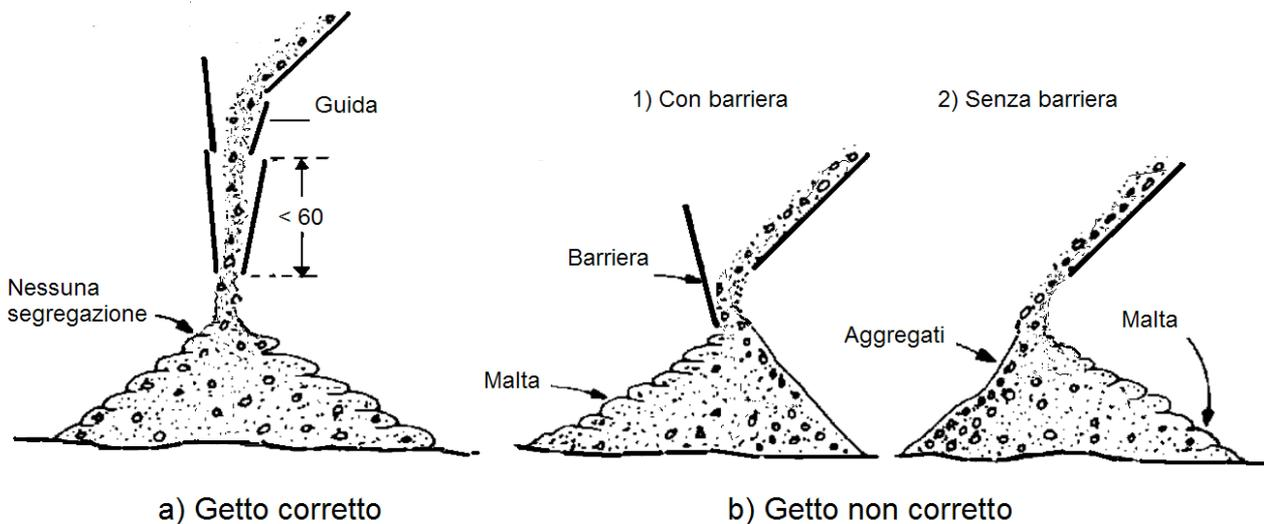
**Figura 58.2 - Esempi di getto di calcestruzzo da piano inclinato: a) getto corretto e b) getto non corretto. Nel caso b) si ha la separazione degli aggregati dalla malta cementizia. La barriera comporta soltanto il cambiamento di direzione della segregazione.**
