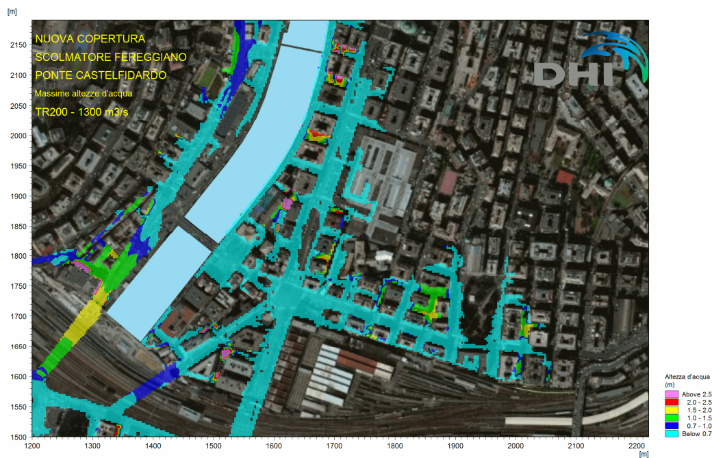
Figura 4.9 Torrente Bisagno – Massimi tiranti idrici degli allagamenti nelle aree in prossimità dell'ex Mercato Generale per effetto di un evento di piena con tempo di ritorno 200 anni, a seguito del completamento degli interventi relativi alla copertura terminale del torrente Bisagno, allo scolmatore del rio Fereggiano e al ponte Castelfidardo.
