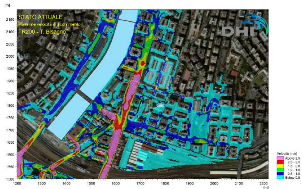
Figura 3.4 Torrente Bisagno – Massime velocità di scorrimento degli allagamenti nelle aree in prossimità dell'ex Mercato Generale per effetto di un evento di piena con tempo di ritorno 200 anni.
