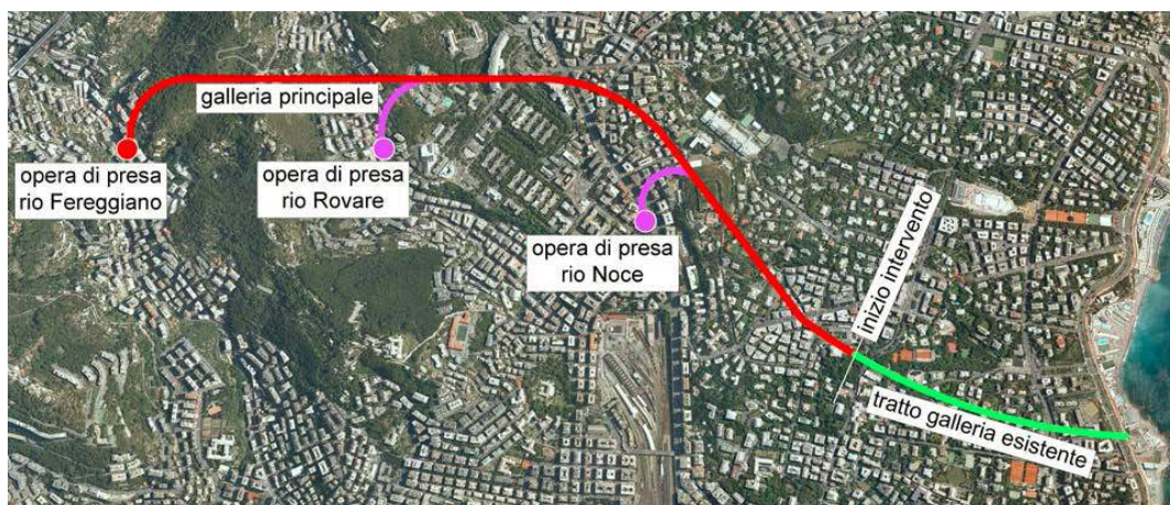
Figura 2.4 Tracciato planimetrico delle opere previste quale primo stralcio del primo lotto (scolmatore del rio Fereggiano, in rosso) del progetto definitivo dello scolmatore del torrente Bisagno.
