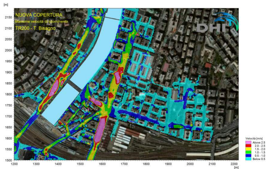
Figura 4.2 Torrente Bisagno – Massime velocità di scorrimento degli allagamenti nelle aree in prossimità dell'ex Mercato Generale per effetto di un evento di piena con tempo di ritorno 200 anni, a seguito del completamento dell'intervento di rifacimento della copertura terminale del corso d'acqua.
