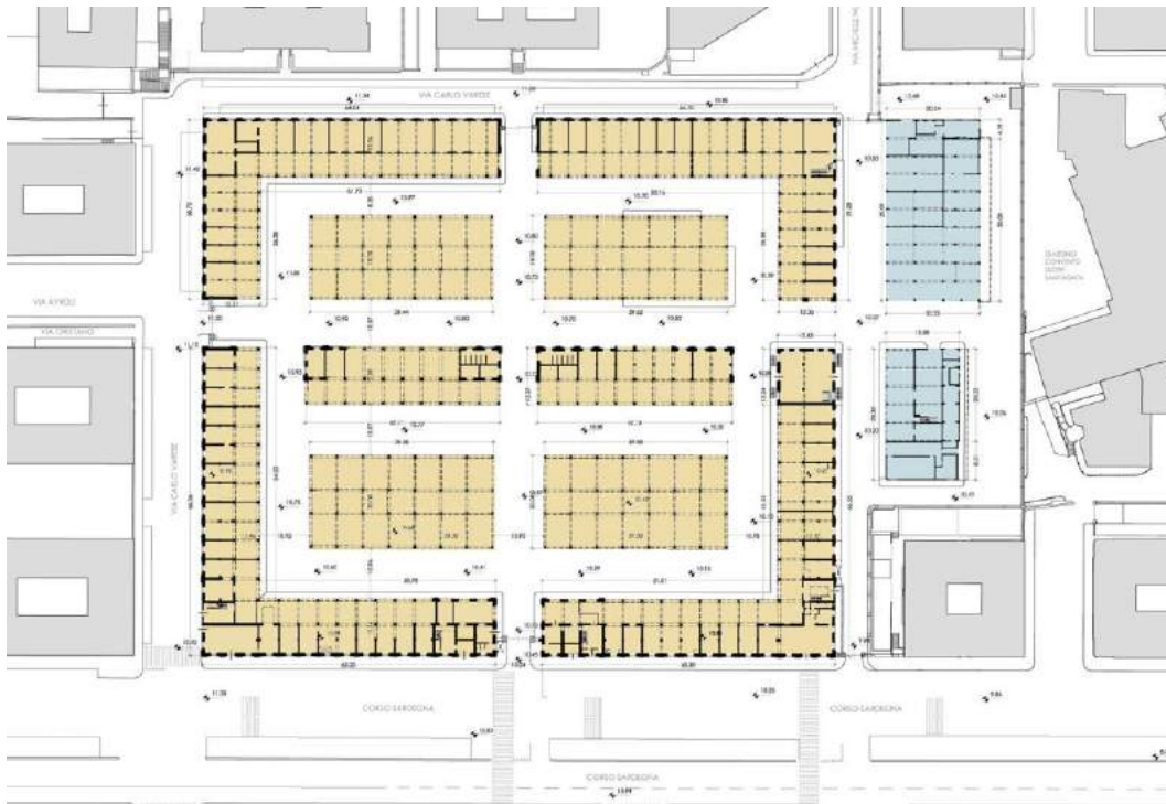
Planimetria dello stato di fatto: in colore beige gli edifici storici, in azzurro i capannoni recenti
