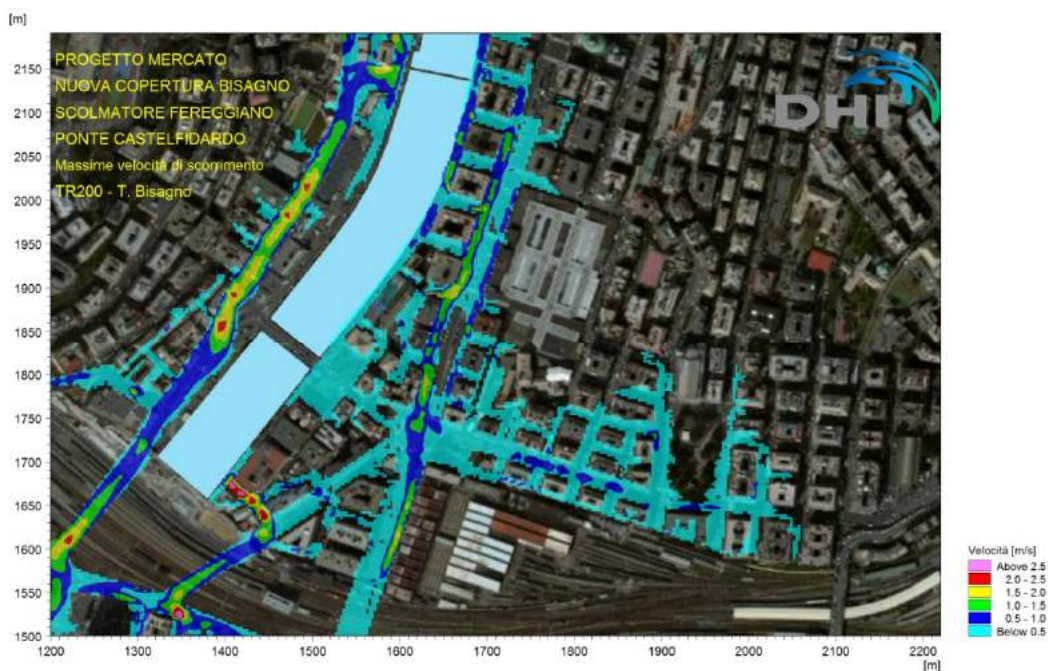
Figura 4.23 Torrente Bisagno – Massime velocità di scorrimento degli allagamenti nelle aree in prossimità dell'ex Mercato Generale (configurazione di progetto) per effetto di un evento di piena con tempo di ritorno 200 anni, a seguito del completamento degli interventi relativi alla copertura terminale del Bisagno, allo scolmatore del Fereggiano e al ponte Castelfidardo.
