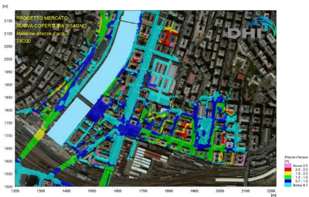
Figura 4.19 Torrente Bisagno – Massimi tiranti idrici degli allagamenti nelle aree in prossimità dell'ex Mercato Generale (configurazione di progetto) per effetto di un evento di piena con tempo di ritorno 200 anni, a seguito del completamento dell'intervento di rifacimento della copertura terminale del corso d'acqua.
