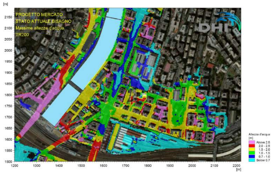
Figura 4.13 Torrente Bisagno – Massime tiranti idrici degli allagamenti nelle aree in prossimità dell'ex Mercato Generale (configurazione di progetto) per effetto di un evento di piena con tempo di ritorno 200 anni.
