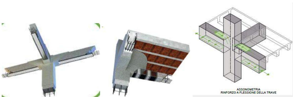
Figura 15: Esempio interventi su trave
