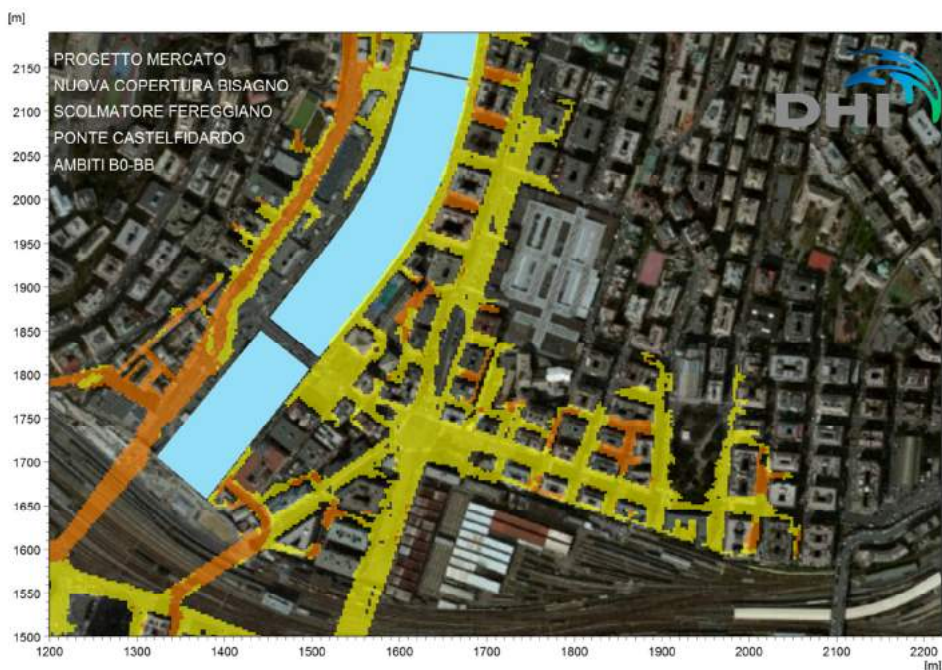
Figura 4.24 Torrente Bisagno – Combinazione dei valori massimi di tiranti idrici e velocità di scorrimento degli allagamenti dell'evento di piena duecentennale, secondo il criterio di definizione degli ambiti normativi di Fascia B, nelle aree in prossimità dell'ex Mercato Generale (configurazione di progetto), a seguito del completamento degli interventi relativi alla copertura terminale del Bisagno, allo scolmatore del Fereggiano e al ponte Castelfidardo.
