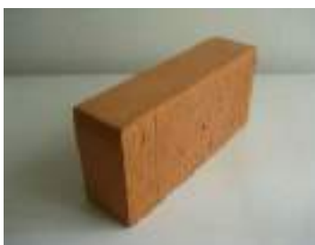
Figura 19.1 - Esempio di mattone pieno \alpha \leq 15\% in laterizio per murature portanti 2
