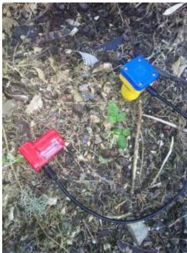
Figura 4 Immagine di dettaglio relativa ai geofoni orizzontali (rossi) e verticali (gialli)
