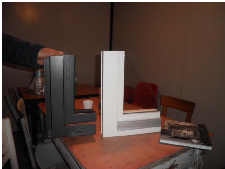
Fig.7) raffronto fra serramento in alluminio col. grigio e serramento in legno col. bianco
