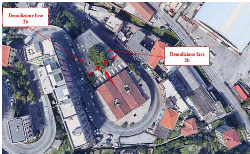
Figura 2: Schema demolizione seconda fase
