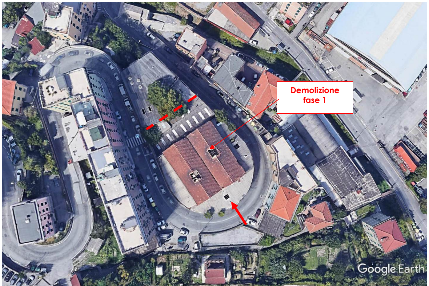
Figura 8: Schema demolizione prima fase
