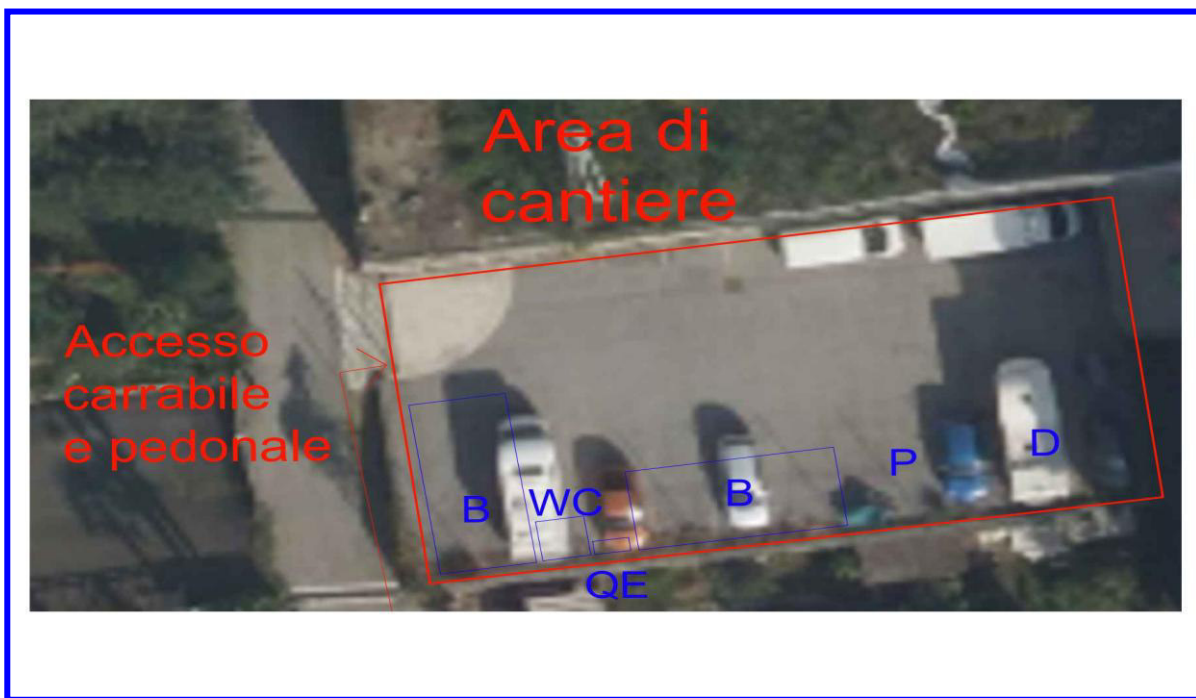
Foto C.2= Inquadramento area di cantiere con evidenziati i baraccamenti
