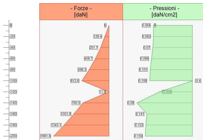
Forze (totali) e Pressioni lungo il fusto, per il Caso 2 ( GEO [ SLU_GEO ] - SLU A2+M2+R2 )
