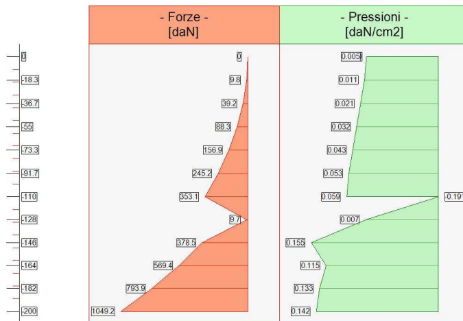
Forze (totali) e Pressioni lungo il fusto, per il Caso 1 ( STR [ SLU ] - SLU A1+M1+R3 )
