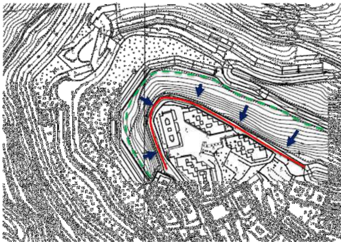
Figura 2 – Stralcio di CTR dell’area in esame con indicazione (in rosso) del tratto di Via A. Robino in oggetto. Le frecce indicano la provenienza del materiale che raggiunge la strada, mentre la linea tratteggiata delimita indicativamente il versante in dissesto.
