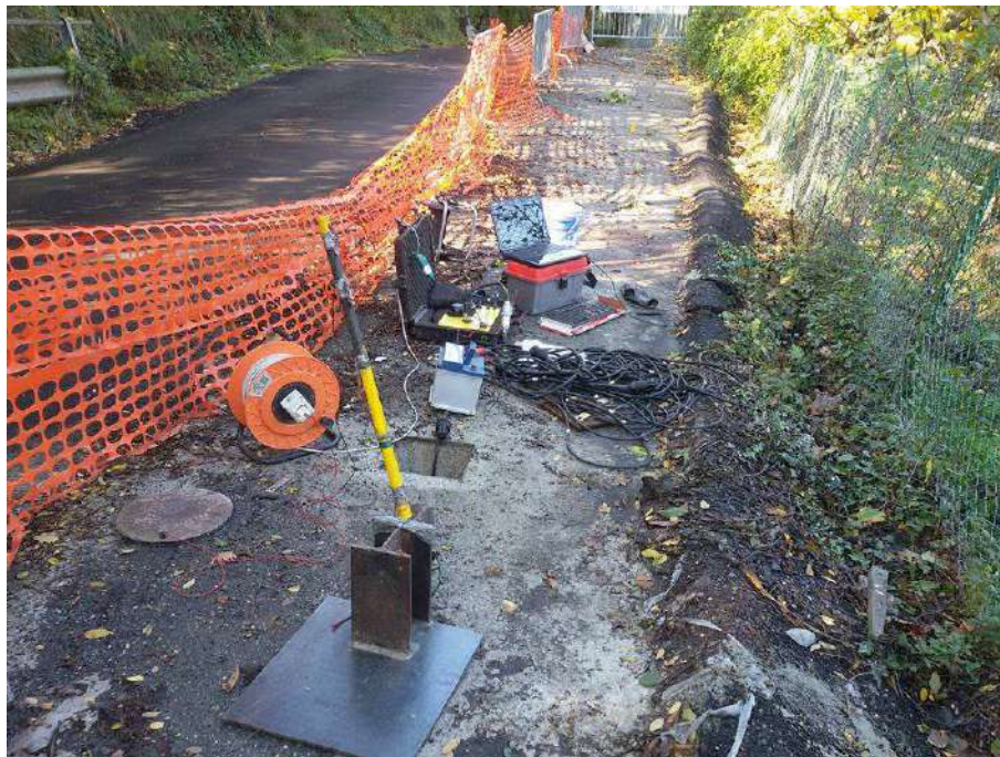
Zona C: prova Down-Hole in corso nella perforazione S3
