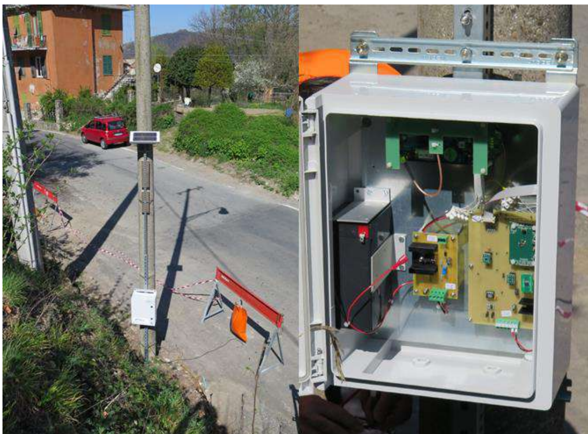
Figura 12: datalogger IoT per gli In Place Inclinometers e pannello solare per alimentazione.
