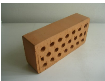
Figura 19.2 - Esempio di mattone semipieno 15\% < \Phi \leq 45\% in laterizio per murature portanti
