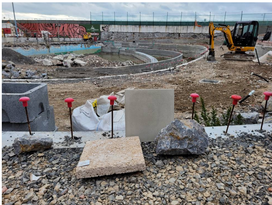
Fig. 15. Campioni del 28.1.2021 Pavimentazione in Natur, cordoli e sedute in cemento colore C 3004, pietra delle scarpate.
