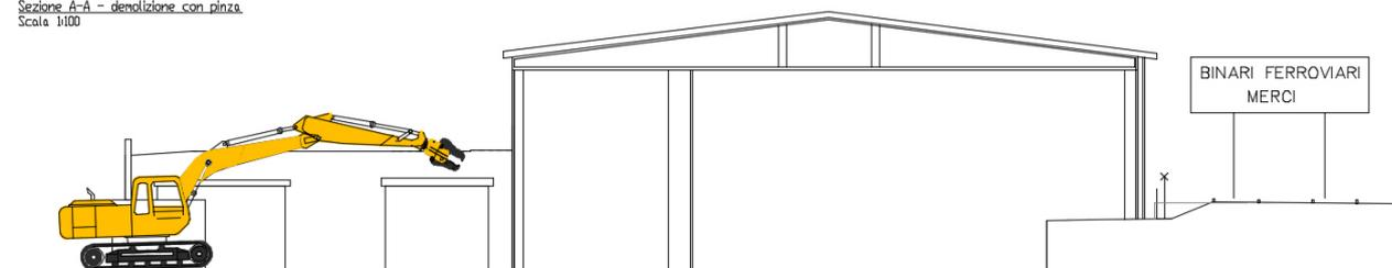
Figura 17: Sezione tipo demolizione con pinza
