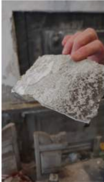
Fig. 16 – Porzioni di intonaco delle pareti colombari nella galleria interna lato sinistro ingresso
