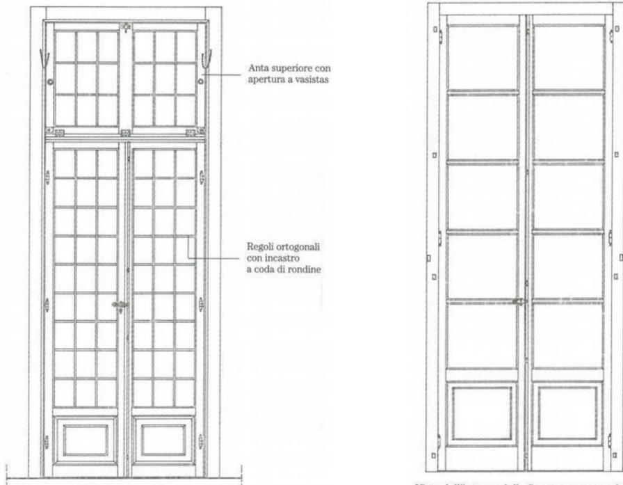
Vista dall'interno della finestra con specchiature cieche nella parte basamentale; le specchiature sono divise da regoli con sezione a T ed incastro a coda di rondine.
