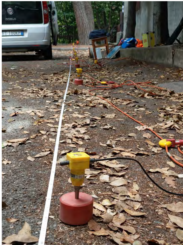
Foto n.4 – particolare stendimento geofisico MASW
