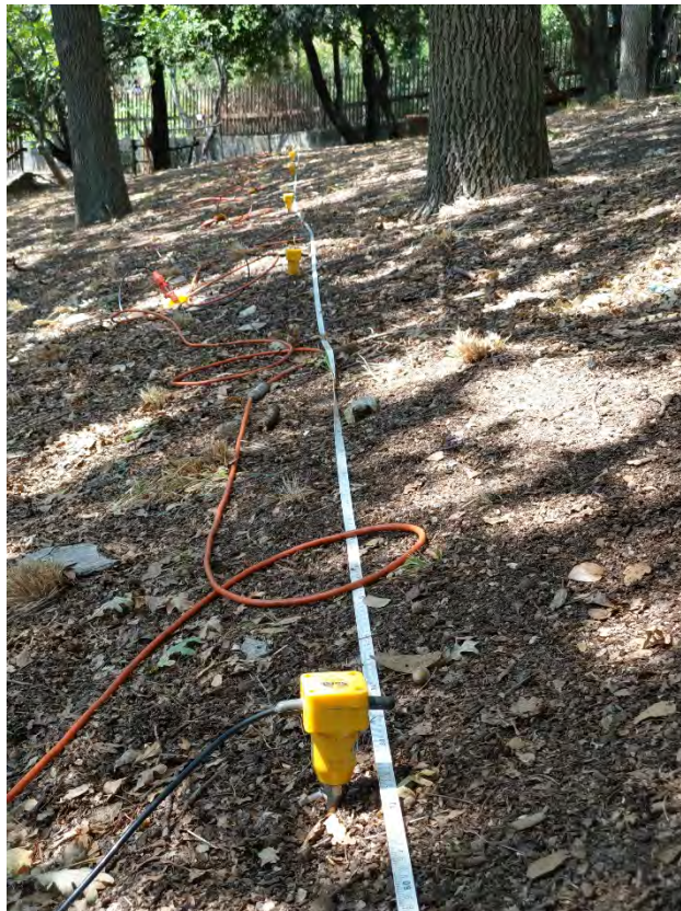
Foto n.8 – particolare stendimento geofisico MASW
