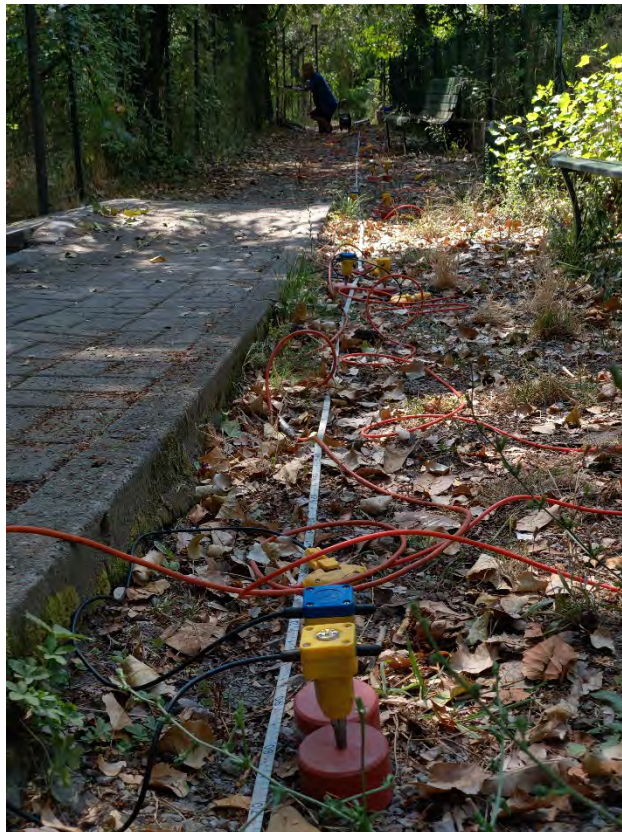
Foto n.10 – particolare stendimento geofisico MASW
