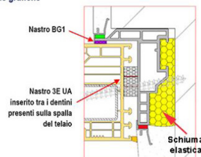
Nodo secondario laterale e superiore: sigillatura della battuta con nastro termo-espandente Hannoband BG1 e sigillatura della spalla con nastro termo-espandente Hannoband 3E UA inserito tra i dentini presenti sulla spalla del telaio. Finitura senza coprifilo
