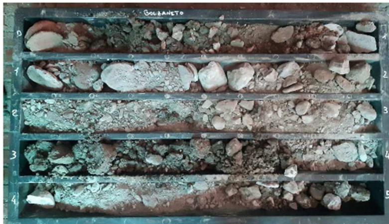
Figura 24 Sondaggio S1 cassetta 2 da 0.00 m a 5.00 m
