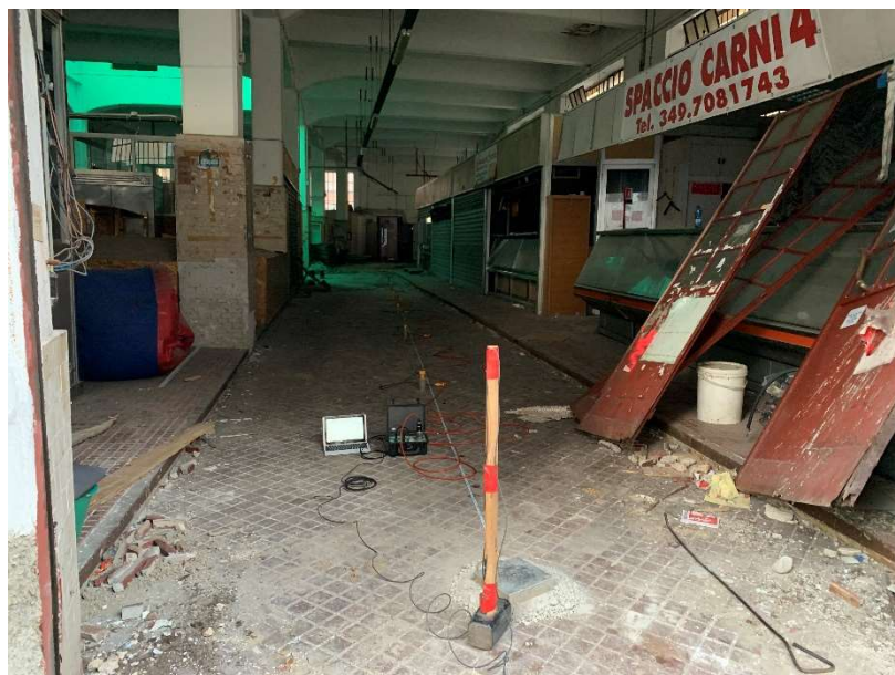
Stendimento sismico M.A.S.W. – L1
