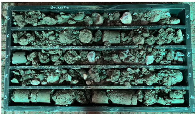
Figura 25 Sondaggio S1 cassetta 2 da 5.00 m a 10.00 m
