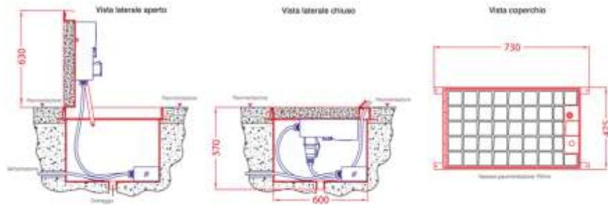
Figura 13 – Viste e dimensioni pozzetto prese (Fonte GIFAS)
