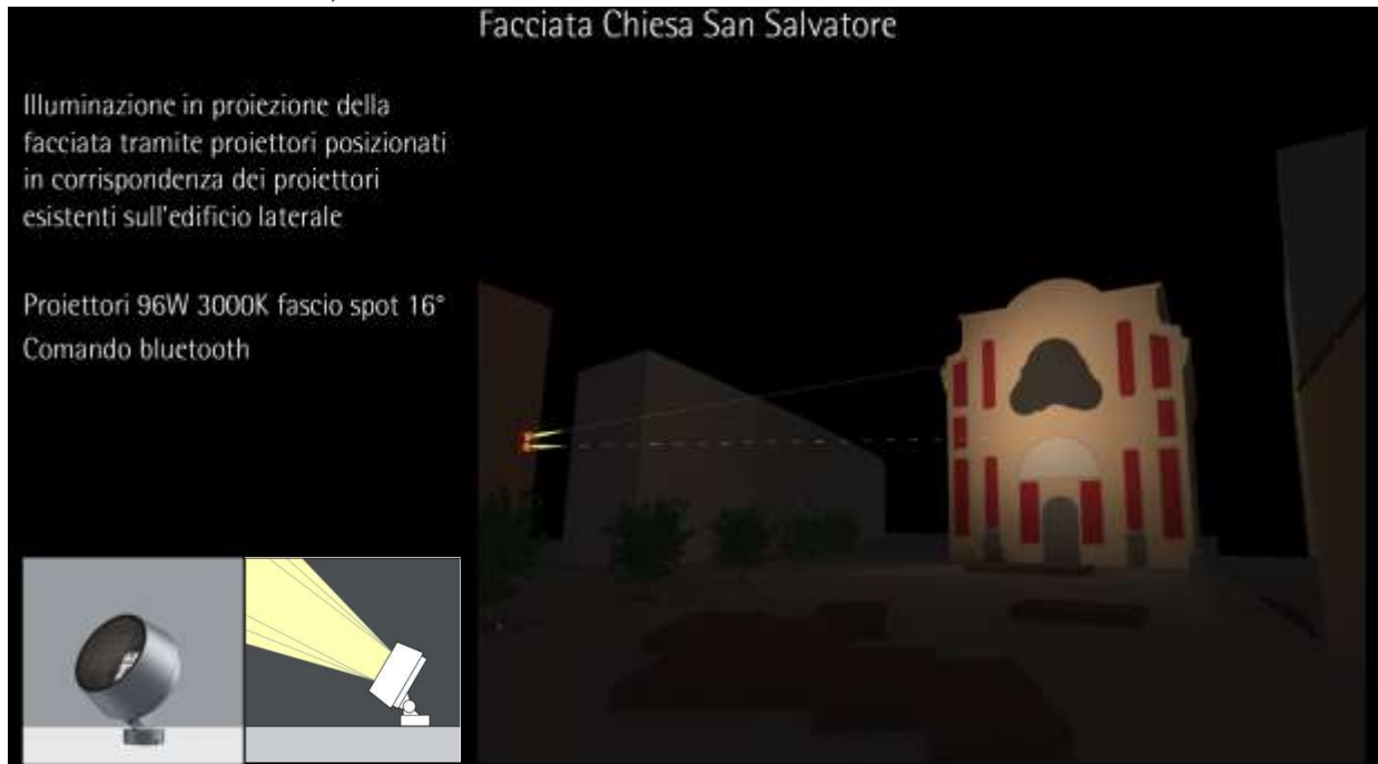
Figura 1 - Schema grafico del nuovo sistema di illuminazione scenografica della Chiesa di San Salvatore (corpi illuminanti E1) - Fonte ERCO
