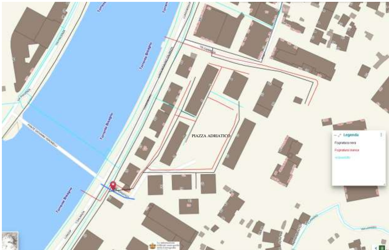
Figura 21 – Stralcio planimetrico delle reti di Fognatura Nera, Bianca ed Acquedotto esistenti (estratto da geoportale)
