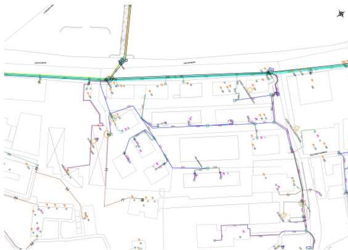
Figura 26 – Stralcio planimetrico della rete OpenFiber esistente (fonte: OpenFiber)
