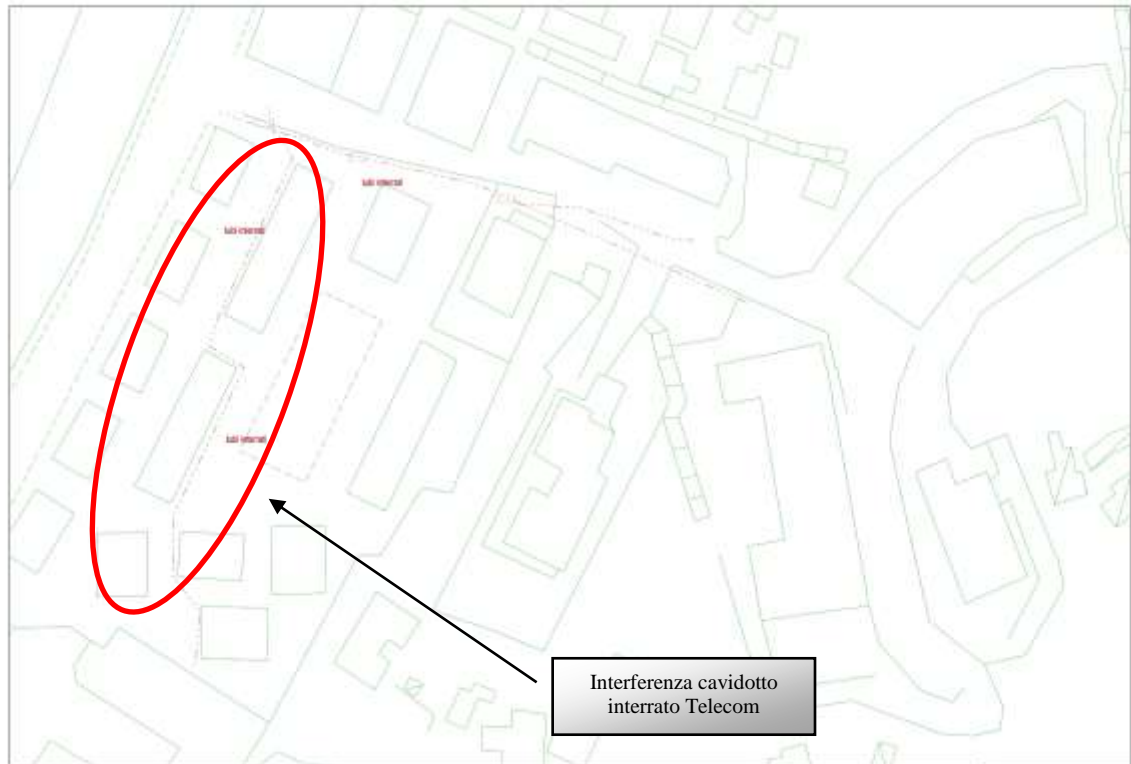
Figura 28 – Stralcio planimetrico dell’impianto Telecom (fonte: Telecom)
