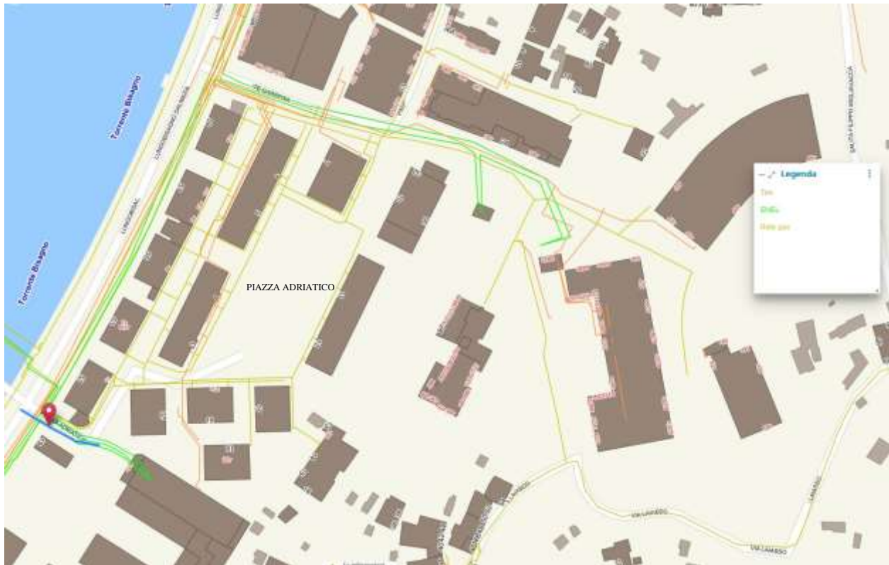
Figura 22 – Stralcio planimetrico delle reti Telecom, E-Distribuzione e rete Gas esistenti (estratto da geoportale)
