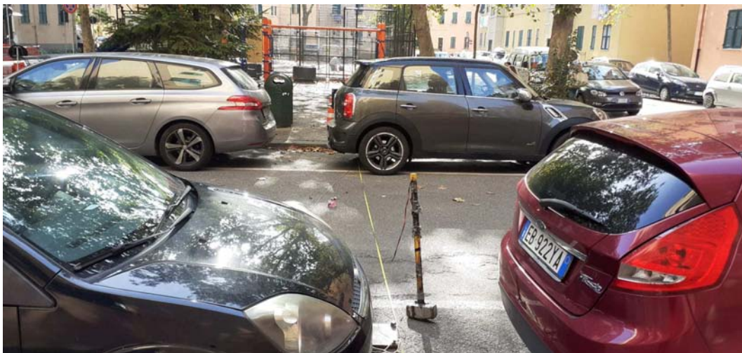
Indagine MASW, piastra di contrasto posizionata nel primo shot point in offset ( D = 10.0 m da geofono G1)
