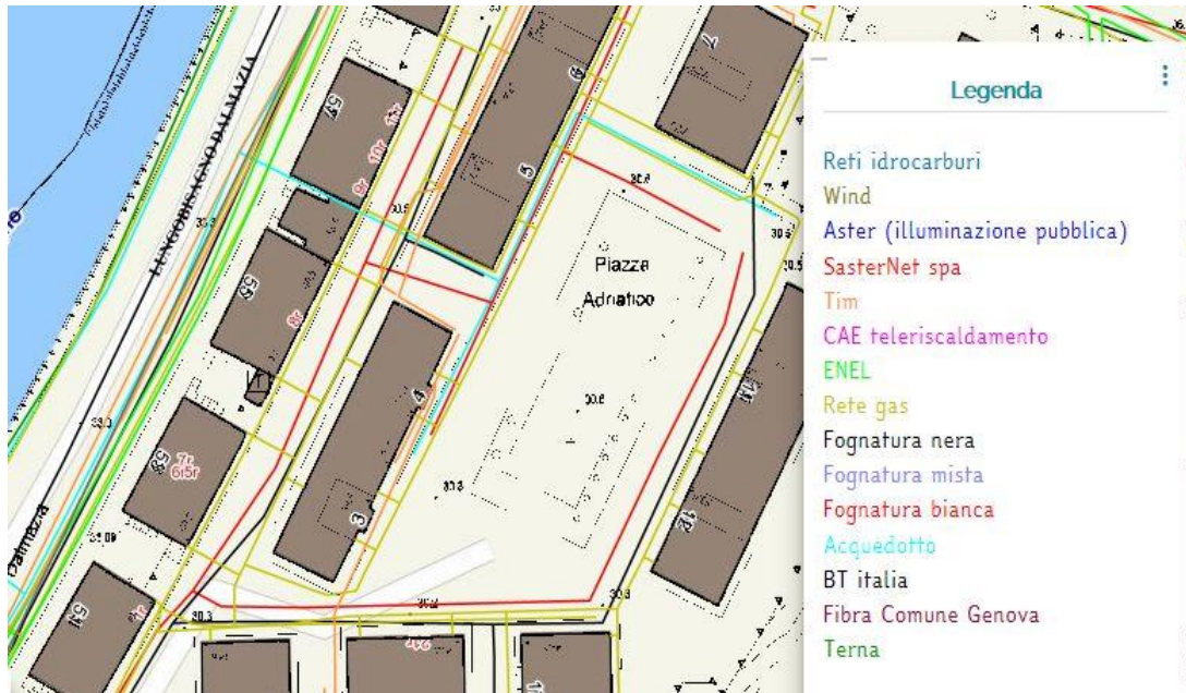
Fig. 9: Planimetria sottoservizi di Piazzale Adriatico (Geoportale Comune di Genova)
