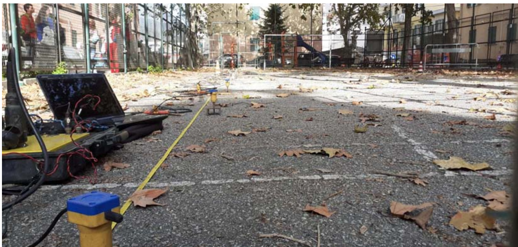
Indagine MASW: array ripreso dall'estremo finale (in primo piano: geofono G20)
