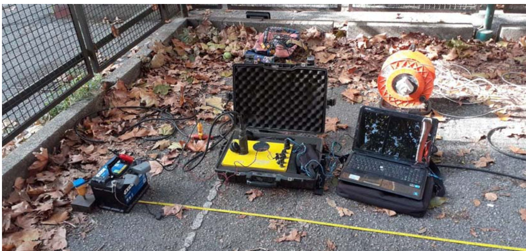
Indagine MASW: sistema di acquisizione Siesmic Source Daq Link III e notebook dedicato
