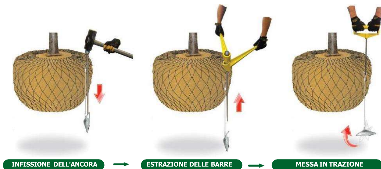
Figura 24 - Esempio di ancoraggio della zolla
