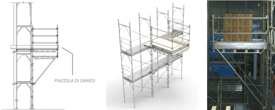
Figura 7 - Ponteggio con piazzola di carico a sbalzo
