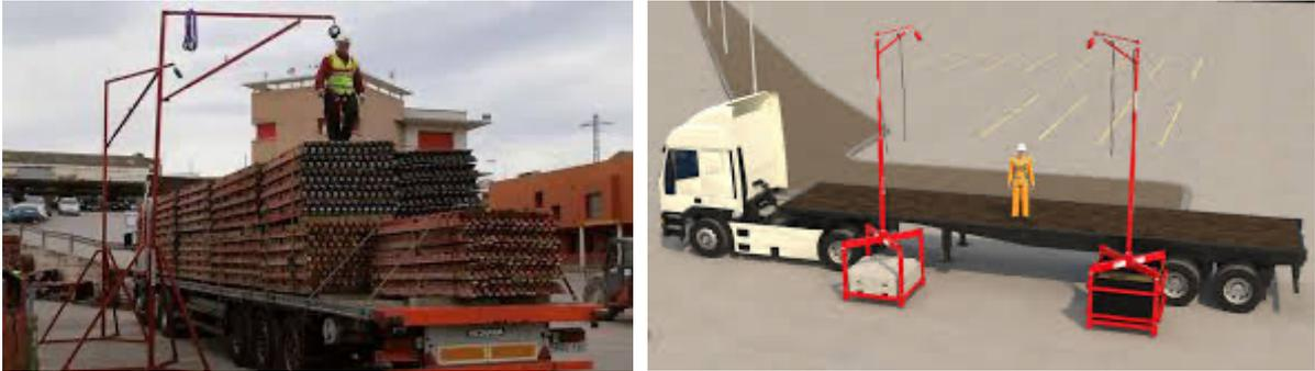
Figura 10 - Esempio di attrezzatura per il carico e scarico mezzi cantiere
