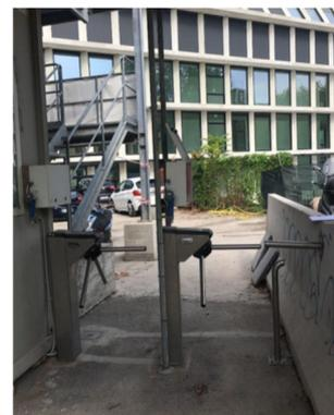
Figura 13 - Esempio di modulo prefabbricato ad uso "guardiana" e di tornelli per gestione accessi
