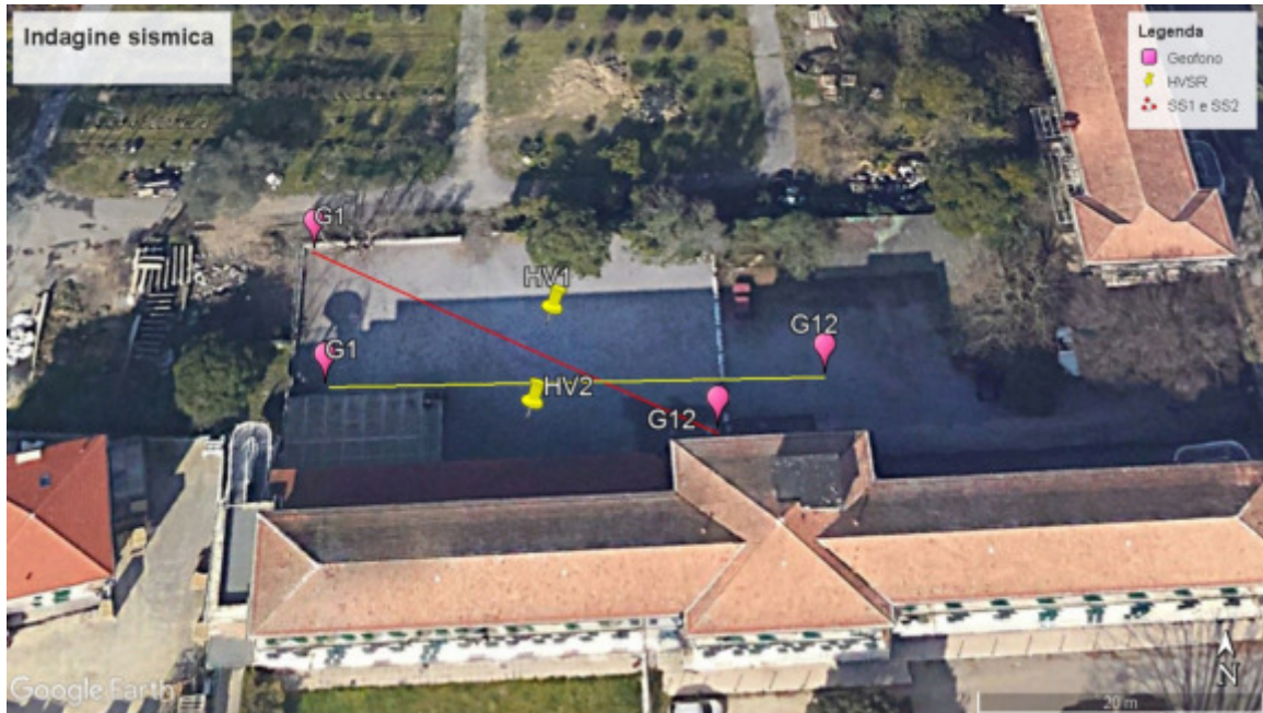
Fig. 23. Localizzazione dell'indagine di sismica attiva MASW (linea rossa SS1 e gialla SS2) e passiva a stazione singola (HV1-HV2). G1 = primo geofono, G12 = dodicesimo geofono.
