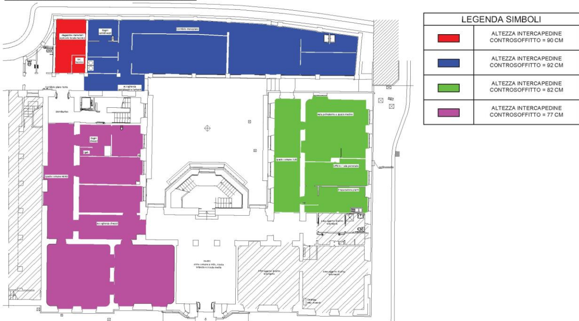
PLANIMETRIA Altezza intercapedini - Controsoffitto
