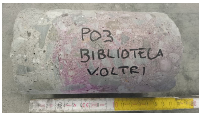
Foto 3 – Carota pilastro P03.
