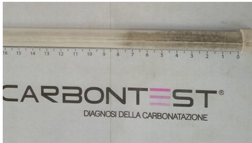
Foto 8 – Carbondiagnostica pilastro P11.
