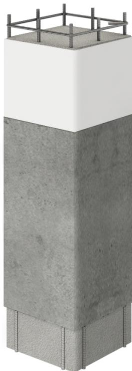
Figura 25. Intervento di rinforzo dei pilastri mediante incamicatura
