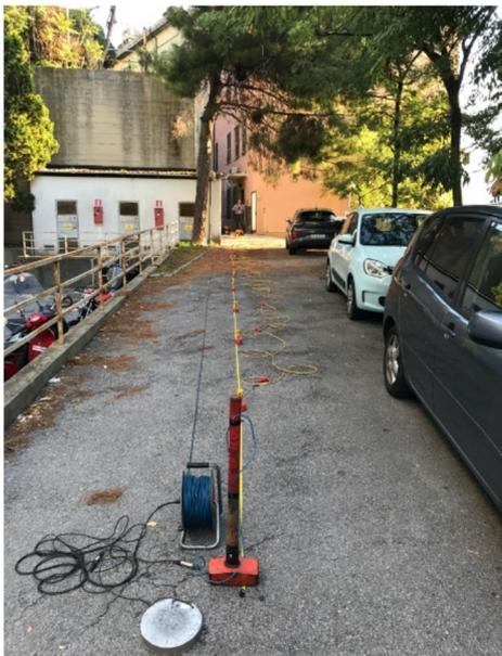
Figura 22 Sismica a rifrazione (Ovest-Est) – sullo sfondo l'edificio oggetto di intervento
