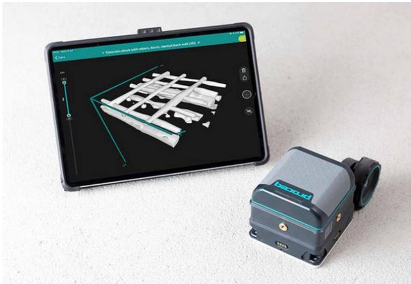
Figura 4 - GPR: strumentazione utilizzata.
