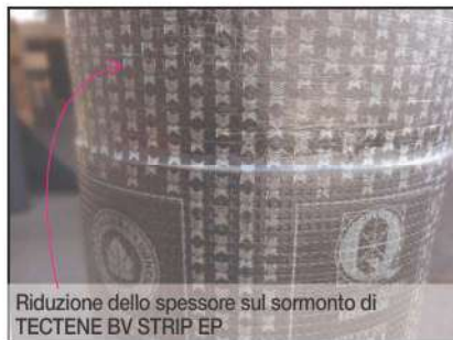
Lo spessore del somonto è inferiore a quello delle strisce garantendo la massima stabilità ai pannelli isolanti posati a cavallo del somonto
