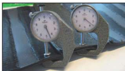
Lo spessore del somonto è inferiore a quello delle strisce garantendo la massima stabilità ai pannelli isolanti posati a cavallo del somonto
