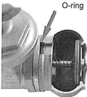
In caso di necessità, (per esempio controllo ed eventuale sostituzione della guarnizione di tenuta) è possibile ispezionare la valvola di non ritorno svitando il corpo principale dalla saracinesca. La tenuta della giunzione filettata è assicurata da apposito o-ring.
