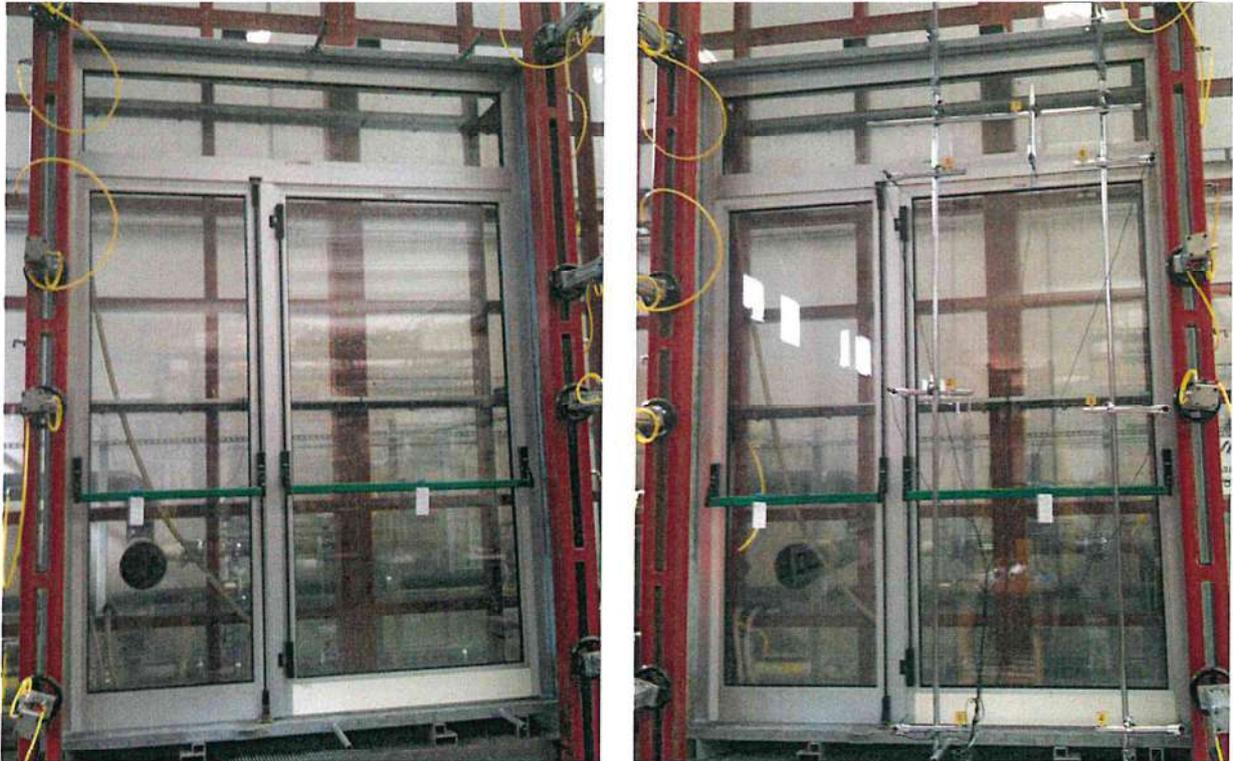
Foto 1 e Foto 2. Campione sottoposto a prova nell'assetto sperimentale e durante i test di resistenza al vento (prova di deformazione)
