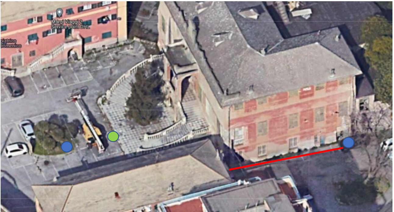
Ubicazioni indagini Penetrometriche e geofisiche
