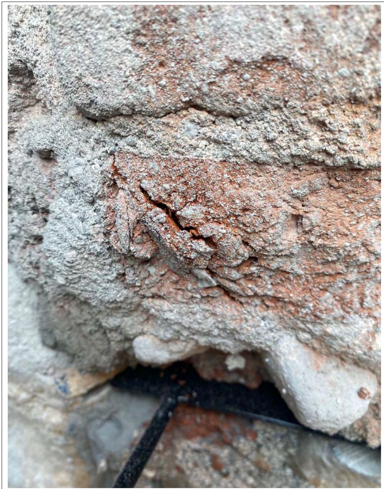
M1 – Rilevamento delle lesioni sui giunti di malta e sugli elementi in pietrame e mattoni, al termine della prova
