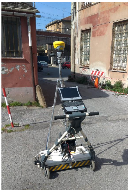
Georadar IDS K2 nella configurazione impiegata per il lavoro in esame.
