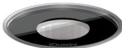
Figura 21 - Corpo illuminante I2 tipo IGuzzini Light Up Orbit, 3000K, 470lm, 6W, IP68 ad incasso o eq.
