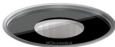
Figura 21 - Corpo illuminante I2 tipo IGuzzini Light Up Orbit, 3000K, 470lm, 6W, IP68 ad incasso o eq.
