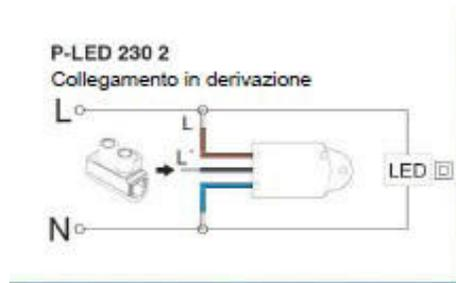
Figura 14 - Schema di collegamento SPD
