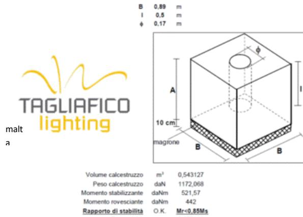
Figura 12 - Tipico costruttivo plinto del palo: infissione diretta del palo nel blocco di fondazione
