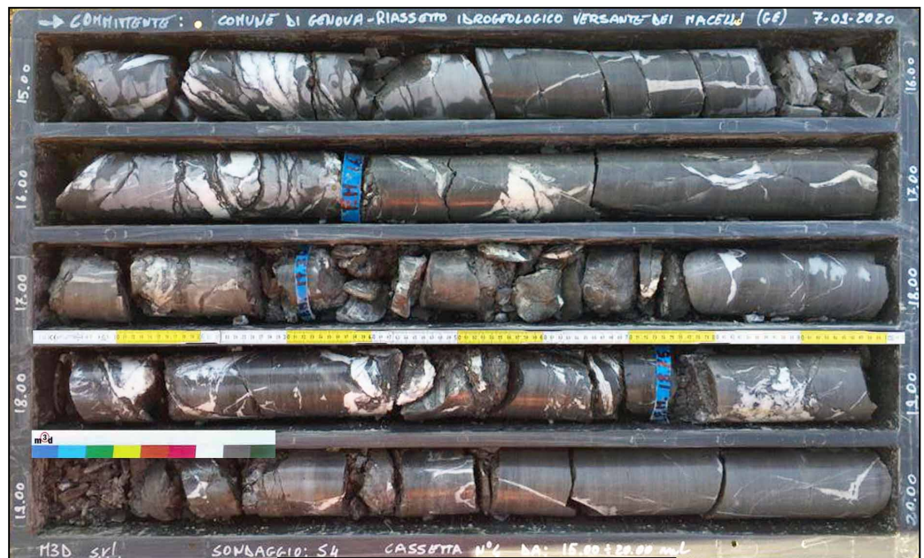
Committente: COMUNE DI GENOVA Sondaggio: S4 - Cassetta: n°4 Prof. da 15.00 m. a 20.00 m. →
