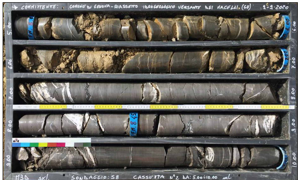
Committente: COMUNE DI GENOVA Sondaggio: S8 - Cassetta: n°2 Prof. da 5.00 m. a 10.00 m. →
