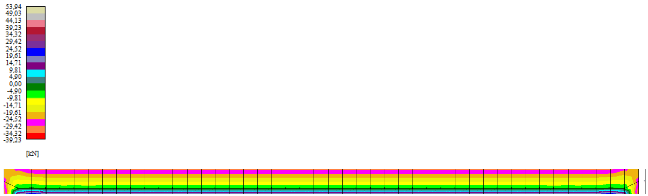
Figura 7.22: Sollecitazioni taglianti paramento verticale caso A+M1 statico
