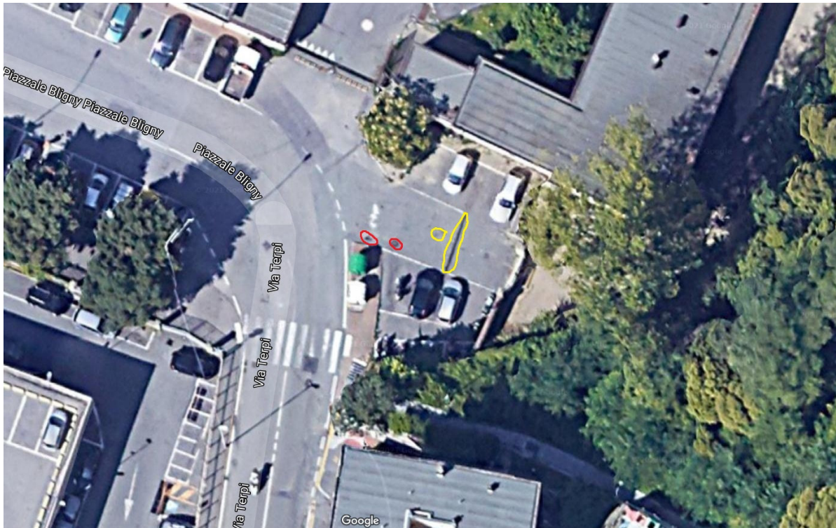
Foto 10: zona antistante al cancello di accesso al piazzale, in giallo sono marcate le caditoie della fognatura bianca, in rosso i pozzetti di ispezione della nera, la fognatura nera guadagna pendenza tra il primo e il secondo pozzetto (rispetto al cancello) e poi si immette nel ramo che arriva da via Mogadiscio
