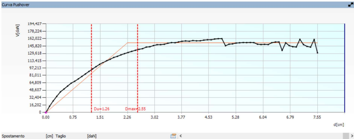
Figura 9.5: Curva di capacità e bilineare equivalente (Analisi 22 – direzione Y)
